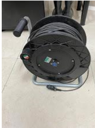
Foto 5 Cable de transmisión del sensor de presión. fuente propia
