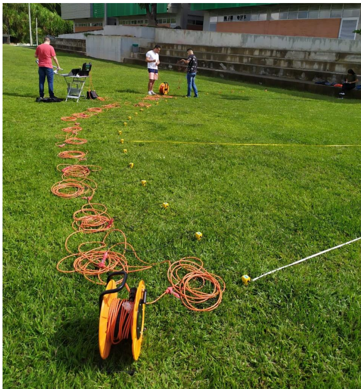
Foto 10 posicionamiento de geófono arreglo radial El Fuente propia
