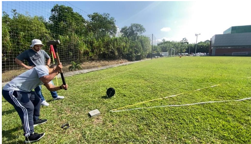
Foto 14 Excitación mediante martillo E3 Fuente propia
