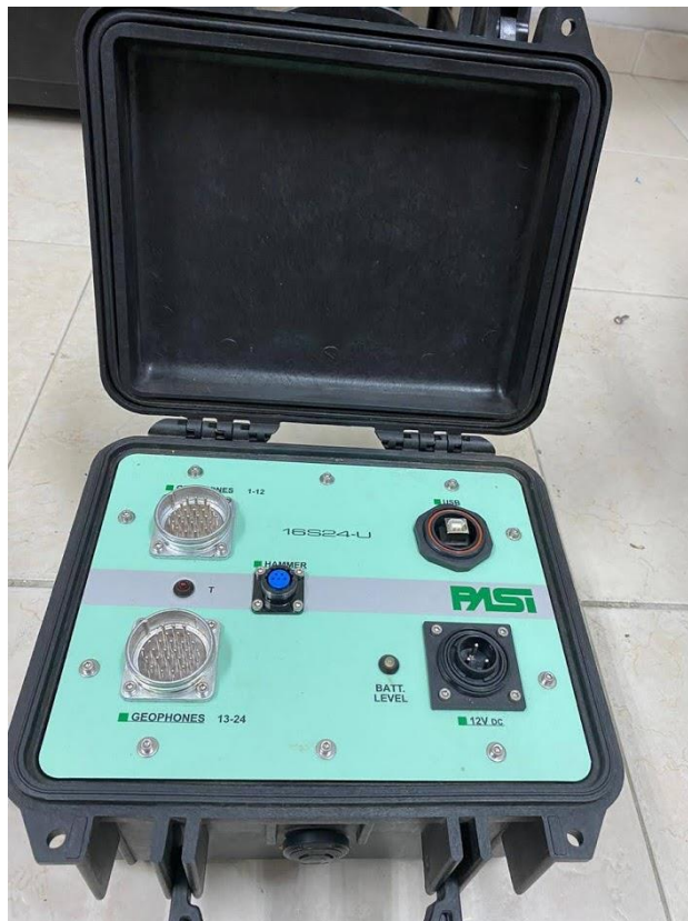
Foto 1 Sismógrafo PASI SEISMOGRAPH 16S – P fuente propia
