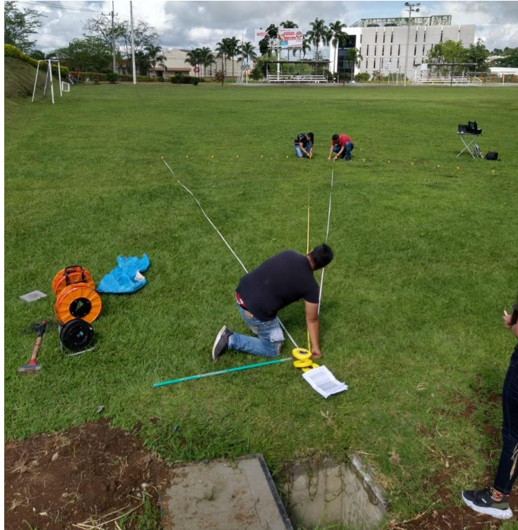
Foto 10 posicionamiento de geófono arreglo radial El Fuente propia
