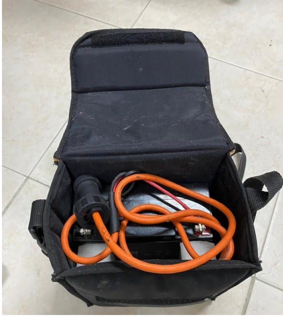
Foto 8 Batería de 12 voltios para proporcionar energía al sismógrafo. fuente propia
