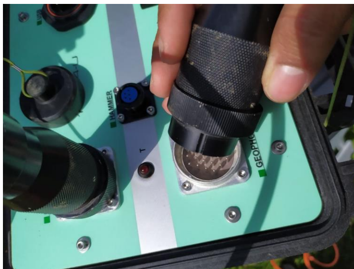
Foto 12 conexión cable de datos a sismógrafo Fuente propia
