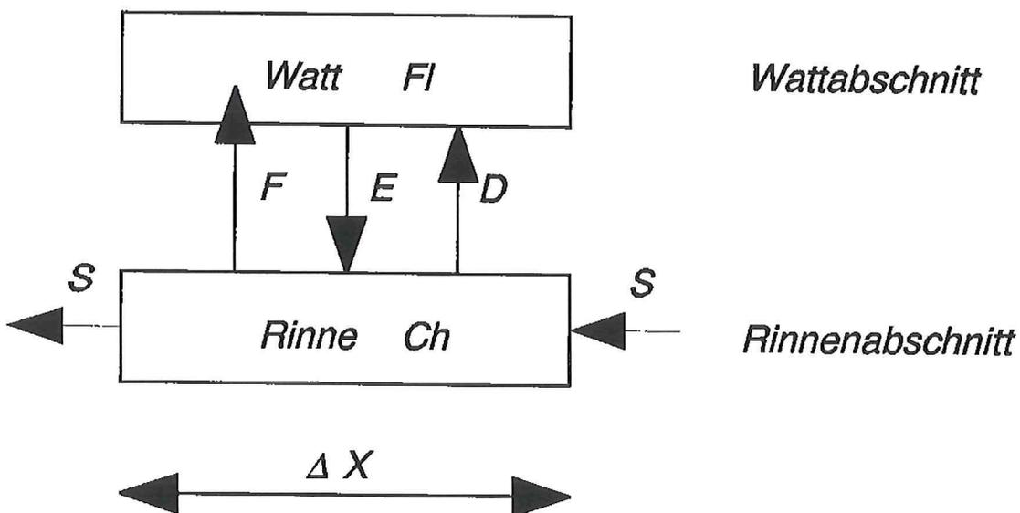
**Abb. 6.4:** Transportkomponenten innerhalb eines Modellbausteins (Box) nach VAN DONGEREN & DE VRIEND (1994)
