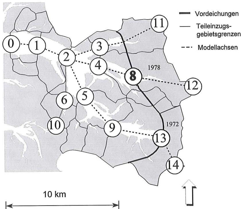
**Abb. 6.7:** Einleitung der Teileinzugsgebiete in der Dithmarscher Bucht in Modellkompartimente (Knoten 9) (NIEMEYER et al. 1995)
