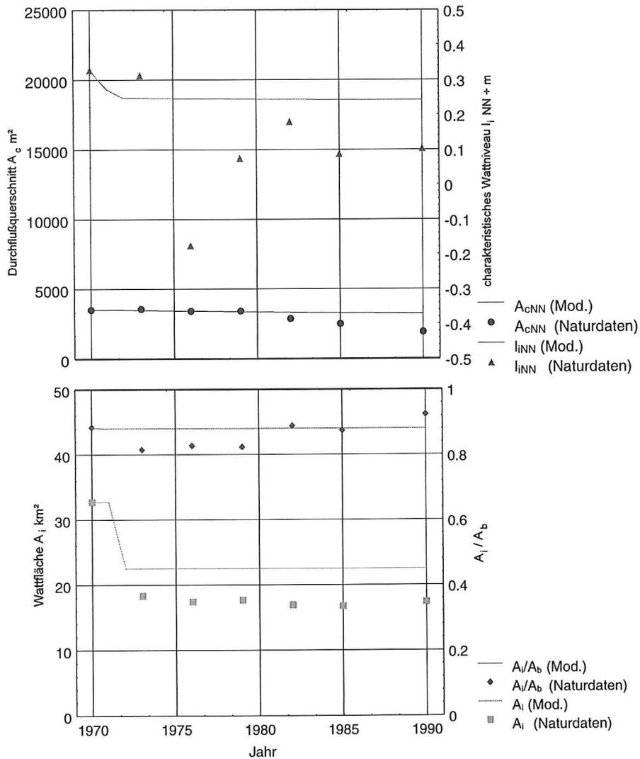
**Abb. 6.9:** Vergleich von Modellergebnissen und Meßdaten für die kennzeichnenden Parameter Mündungsquerschnitt, charakteristisches Wattniveau, Gezeitenfläche und Relation von Gezeiten- und Einzugsgebietsfläche für das Teileinzugsgebiet Speicherkoog (Knoten 9, Abb. 6.7) in der Dithmarscher Bucht mit Sedimenttransport von den Wattoberflächen zu den Rinnen (NIEMEYER et al. 1995)
