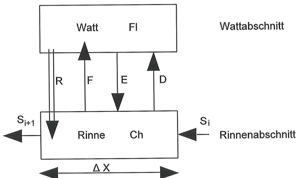
**Abb. 6.6:** Erweiterung der Transportvorgänge im Modell TIDYN durch Sedimenttransport  $R$  in die Rinne infolge Erosion der Watten des zugehörigen Watteinzugsgebietes (NIEMEYER 1994)
