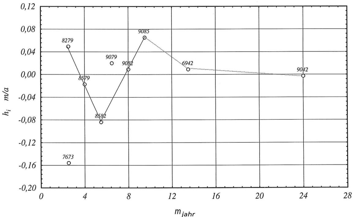
**Abb. 4.18:** Entwicklung der Umlagerungsrate nach einer Störung; Teileinzugsgebiet Speicherkoog
