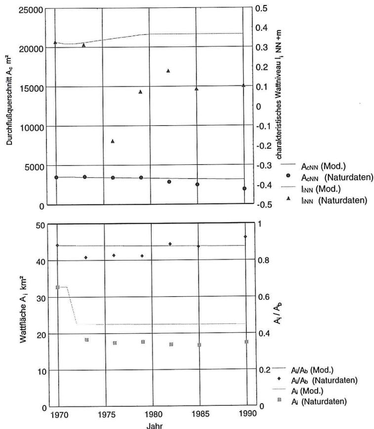
**Abb. 6.8:** Vergleich von Modellergebnissen und Meßdaten für die kennzeichnenden Parameter Mündungsquerschnitt, charakteristisches Wattniveau, Gezeitenfläche und Relation von Gezeiten- und Einzugsgebietsfläche für das Teileinzugsgebiet Speicherkoog (Knoten 9, Abb. 6.7) in der Dithmarscher Bucht (ohne Sedimenttransport von den Wattoberflächen zu den Rinnen) (NIEMEYER et al. 1995)
