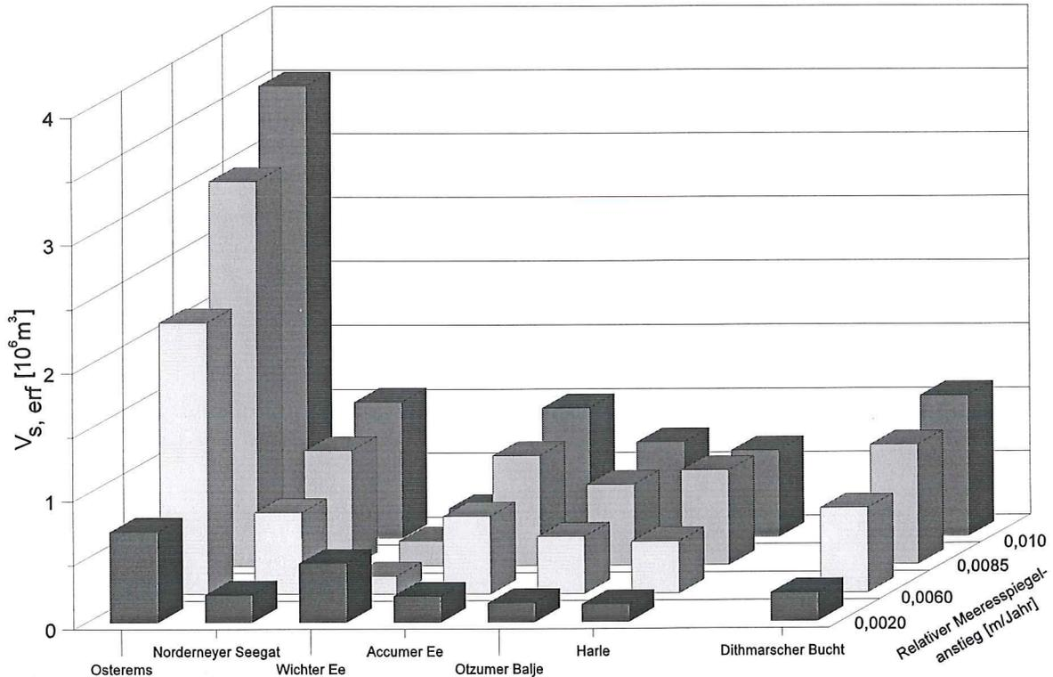
**Abb. 5.1:** Durchschnittlich pro Jahr erforderliche Sedimentvolumen  $V_{s,erf}$  für den Erhalt des morphodynamischen Gleichgewichts unter Annahme verschiedener Szenarien des relativen Meeresspiegelanstiegs (Ostfriesisches Wattenmeer und Dithmarscher Bucht) (NIEMEYER et. al 1995)
