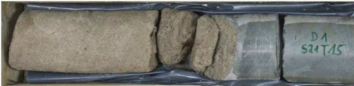
Bild 4: Scharfer Übergang von der Düsenstrahlsäule zum Baugrund
