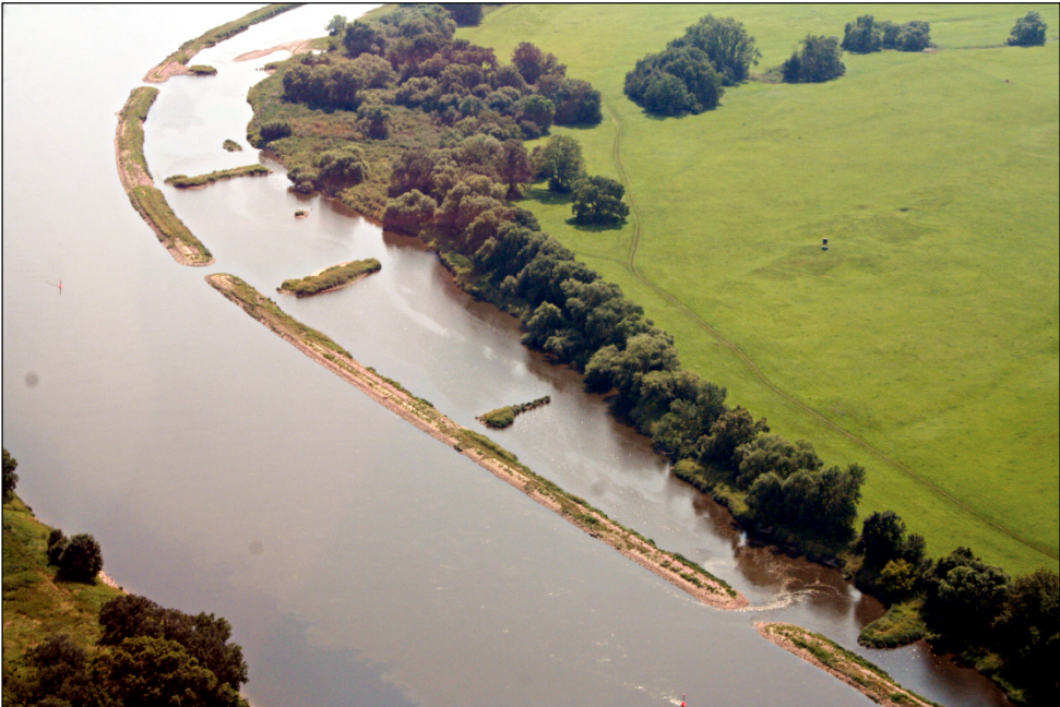
Abb.12: ökologisch verbessertes Leitwerk mit Inselbereichen, durchströmten Öffnungen und initiierten Uferabbrüchen bei Dessau-Wallwitzhafen (Foto: G. Puhmann).
