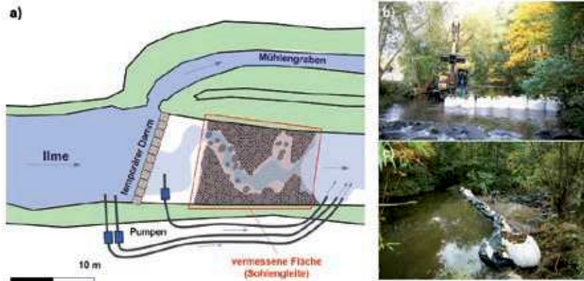
Abbildung 3: a) Prinzipskizze zur Trockenlegung der Sohlgleite, b) Einheben der Bigbags, c) fertiggestellter Damm (Grafik, Fotos: Eikenberg)
