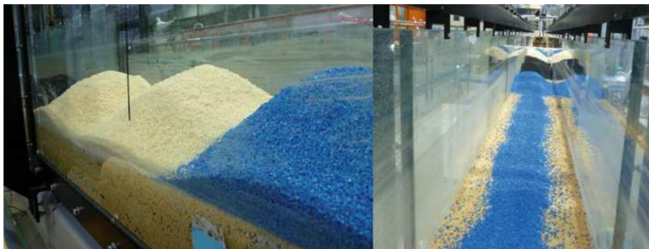
Bild 5: Einzelfractionen der Kunststoffgranulate in der Versuchsrinne nach dem Einfüllen
