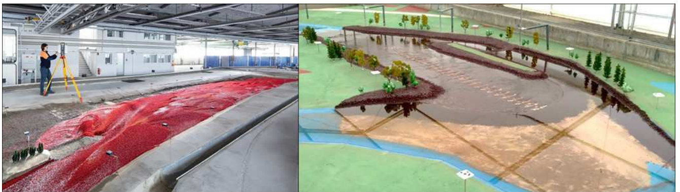
Bild 1: Modell der Isarmündung in die Donau (links) und Modell der Sohlengleite Oste in Bremervörde (rechts) mit mehreren Kunststoffgranulat Fraktionen als Modellsediment
