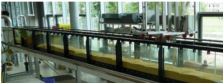
Bild 4: Fotografie der Versuchsrinne b = 0,30 m im Versuchsbetrieb
