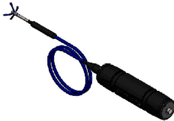
Abb. 4.8: ADV-Sonde vom Typ Vectrino Plus und Profiler (Nortek AS 2012)
