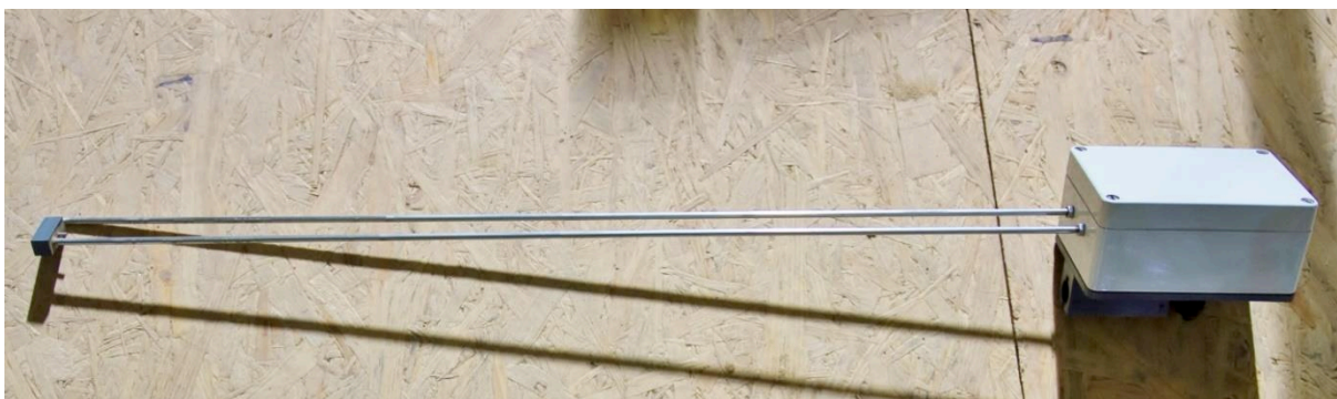
Abb. 4.13: Induktiver Widerstandsdrahtpegel vom Typ GHM Wave Height Meter
