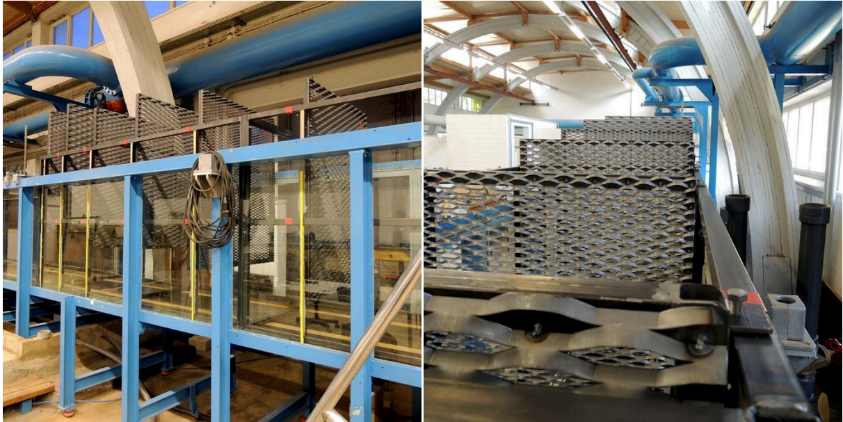
Abb. 3.10: Versuchseinbau des Prototyps der passiven Wellenabsorption in der Strömungsrinne zur Untersuchung der Durchströmung.
