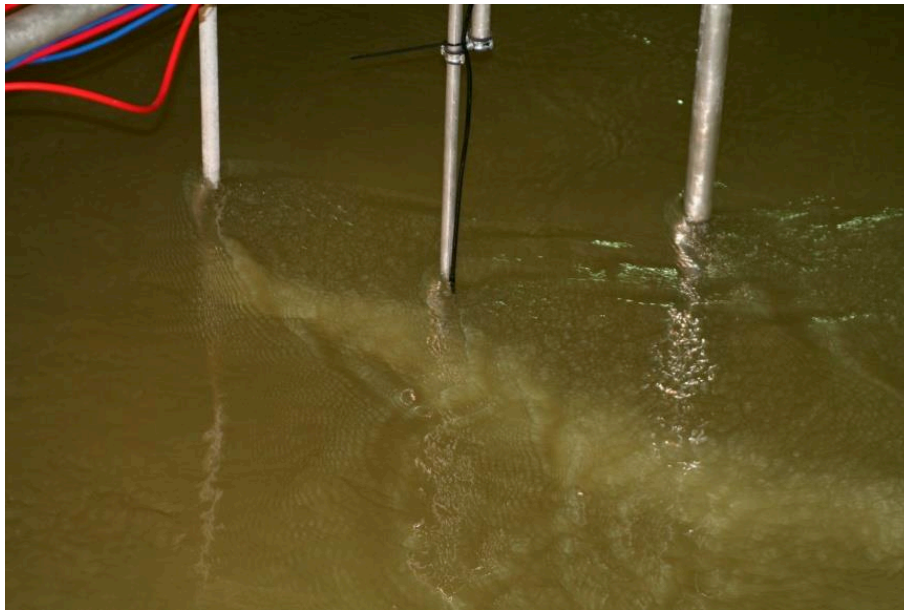
Abb. 5.22: Injektionslanze mit Haltestange bei Strömungsversuchen (Lieske 2015)
