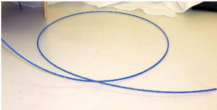
Abbildung 8: Strukturiertes Dehnungsmesskabel
