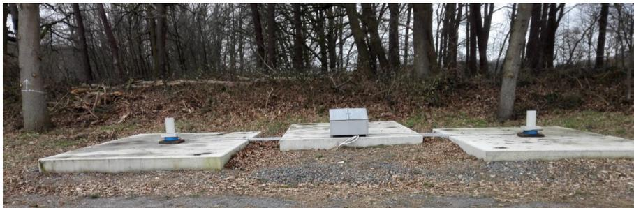
Abbildung 4: Anker FA1 bis FA3 im eingebauten Zustand mit Betonwiderlager, Messstation, Kraftmessdosen (blau) und Schutzkappe (weiß)
