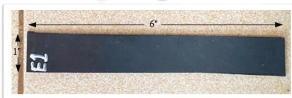
*Nota.* Medidas basadas en la norma ASTM 6392 para pruebas de tracción. Elaboración propia.
