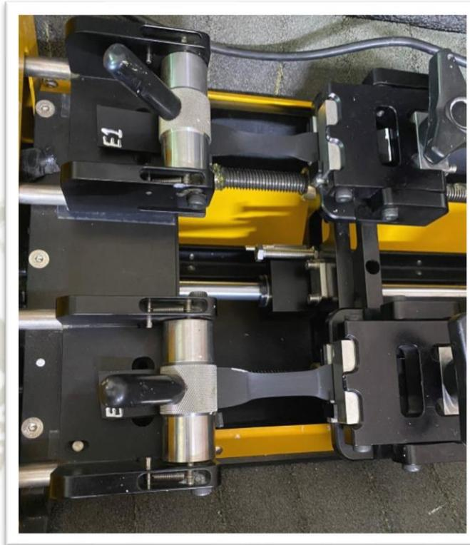
*Nota.* Muestras de geomembrana de HDPE no cubiertas por el aditivo, sometidas a prueba de tracción. desarrollado en equipo de tracción Demtech Pro-Tester Elaboración propia.
