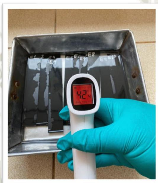
*Nota.* En la imagen vemos muestras de geomembranas sumergidas en el agua acidulada.
