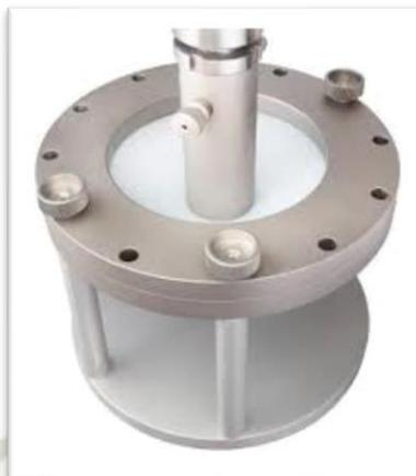
*Nota.* Elemento para la prueba de ruptura de la geomembrana, ASTM D6241 tomado Eieinstrument (2020)
