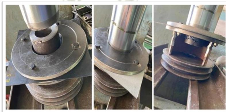
*Nota.* Elaboración propia, pruebas de perforación realizadas a geomembranas de 2mm tanto cubiertas como no cubiertas, con los elementos diseñados especialmente para esta prueba.
