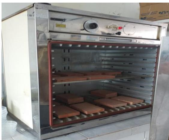
**Figura 32.** Secado anhidro de probetas
