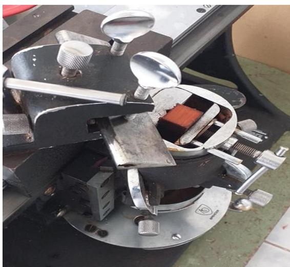
**Figura 23.** Corte de láminas a partir de los cubos
