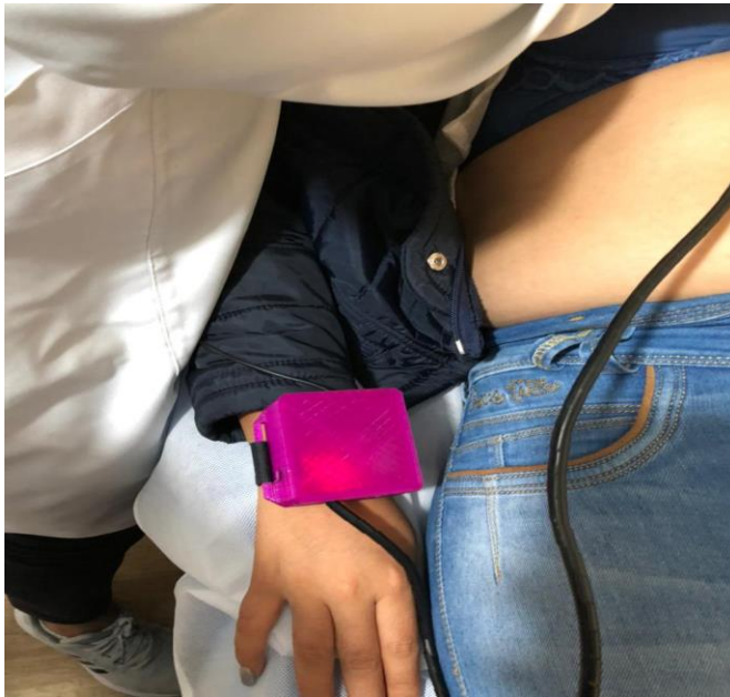
Figura 47 Medidor de ritmo cardiaco colocado en muñeca derecha de paciente 3.
