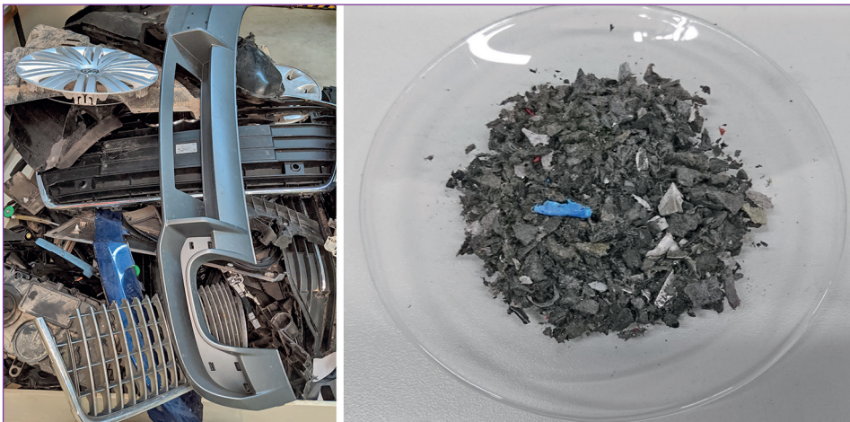
Bild 2: AKAW unzerkleinert (links) und geschreddert auf < 10 mm (rechts) für den Einsatz im Schneckenreaktor
