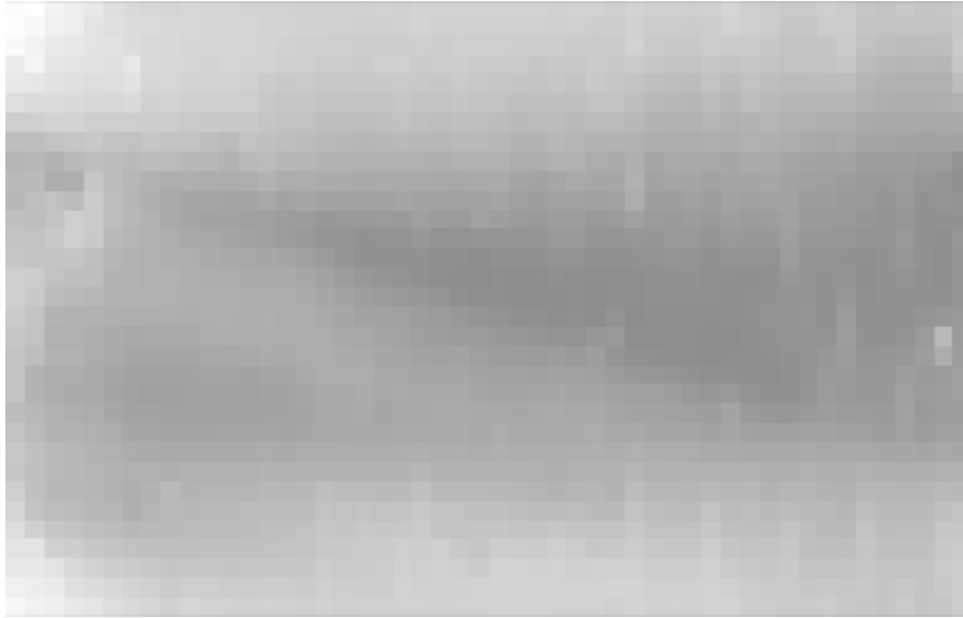
FIGURE 3.3 – La matrice de pixels permettant de visualiser une projection en deux dimensions d’un billot. Chaque pixel représente la distance entre le centre du billot et sa surface. Une ligne représente l’information pour un angle donné. Une colonne représente l’information pour une distance donnée prise sur la longueur à partir de l’origine du billot.
