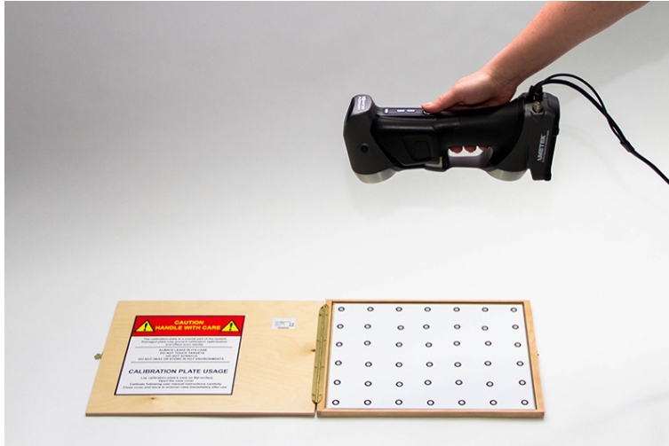
FIGURE 5.7 – Utilisation de la plaque de calibration. Tiré de [101].
