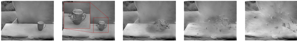
FIGURE 0.3 – Reconstruction vidéo à partir de données d'une caméra événementielle. La vidéo est reconstruite jusqu'à 8000 trames par seconde dépendant du mouvement dans la scène. Tiré de [58].
