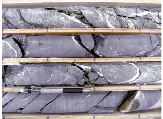
第1図 新鮮帯のコア写真。高角の層理面および節理面が発達しており、白色を呈する方解石脈により充填されている。コアは暗灰色を呈し、硬質である。BV-2の深度-20m付近。
