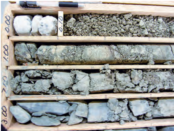
第3図 強風化帯のコア写真。方解石脈は消失している。コアは礫状～土砂状を呈し、褐色化が進行している。深度0m～-0.1mの白色コアはモルタル。BV-2の深度0～-3m付近。
