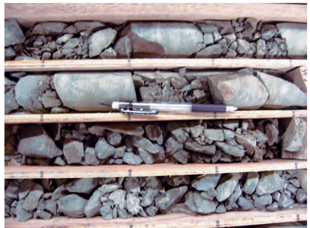
第2図 弱風化帯のコア写真。方解石脈が大半が消失してクラックが開口するとともに、コアは岩片状~礫状を呈する。岩片そのものは硬質だが、開口したクラックに沿って褐色化する。BV-2の深度-6m付近。
