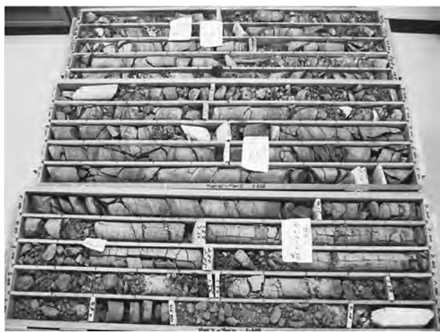
図 2. 藤川層泥岩のコア試料 (BH-1)。
