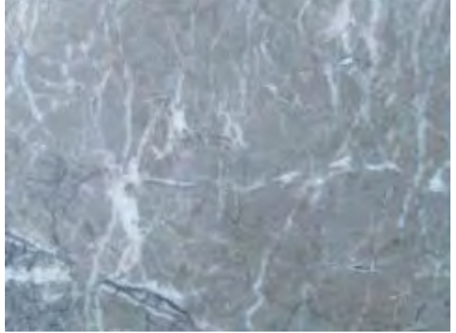
図 5b 「淡雪」研磨面. 阿南市加茂町黒河で採集した大理石. 左右 16cm.
