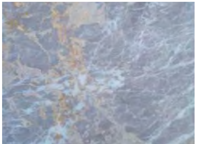
図 4b 「時鳥」研磨面. 阿南市阿瀬比町亜利田で採集した大理石. 左右 18cm.
