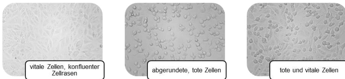
**Abbildung 3: Morphologische Beurteilung mittels Phasenkontrastmikroskopie**
