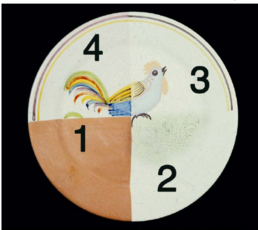
Les 4 étapes de la fabrication : 1 biscuit, 2 émailage en cru et poncis, 3 peinture, 4 cuisson.
