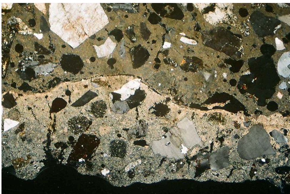
CLU 98-056 D (optique x 2), vue en coupe du revers de l'enduit comprenant une couche d'apprêt (?) riche en chaux transformée en calcite en lumière naturelle et polarisée.
