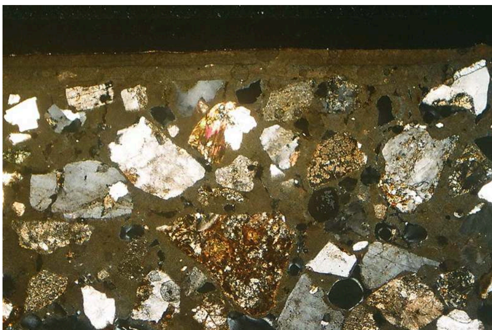
CLU 41-015 C (optique x 2), vue en coupe de l'enduit et de sa couche picturale en surface, en lumière naturelle et polarisée.
