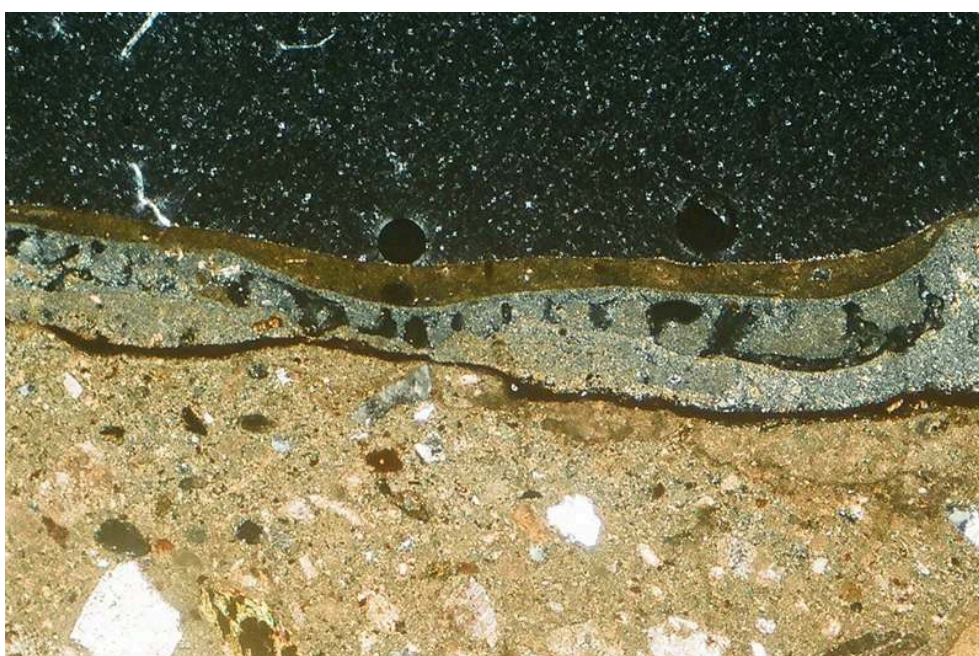
CLU 22-075 K (optique x 4), zoom sur la coupe de la surface avec l'enduit lissé le badigeon blanc et la couche picturale, en lumière naturelle et polarisée. On distingue en lumière polarisée l'abondance de la calcite dans l'enduit de support.
