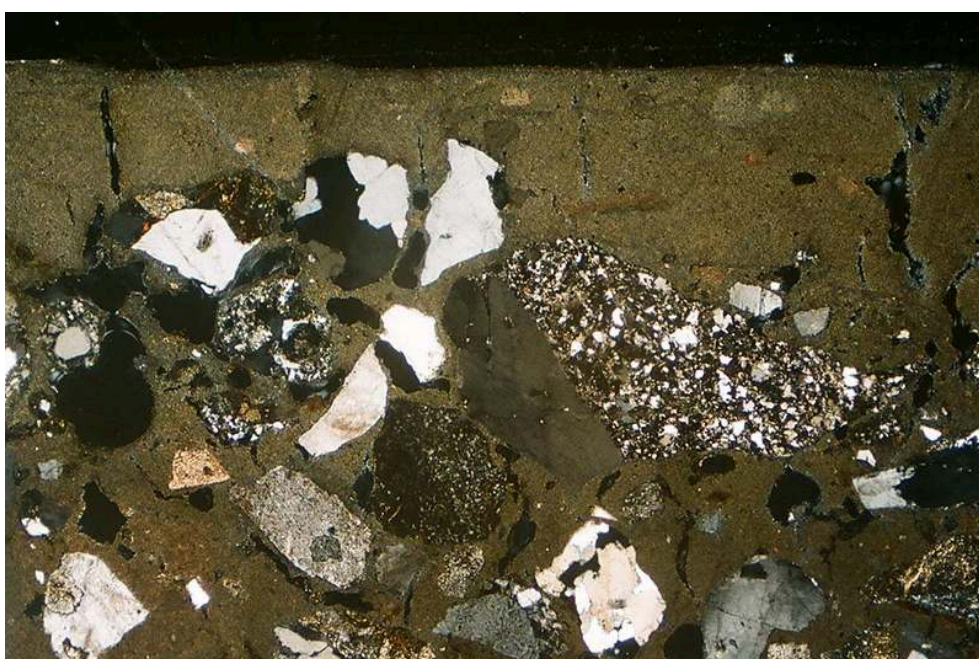
CLU 98-056 D (optique x 2), vue en coupe de l'enduit, du badigeon épais qui égalise la surface et de la mince couche picturale jaune appliquée en surface en lumière naturelle et polarisée.
