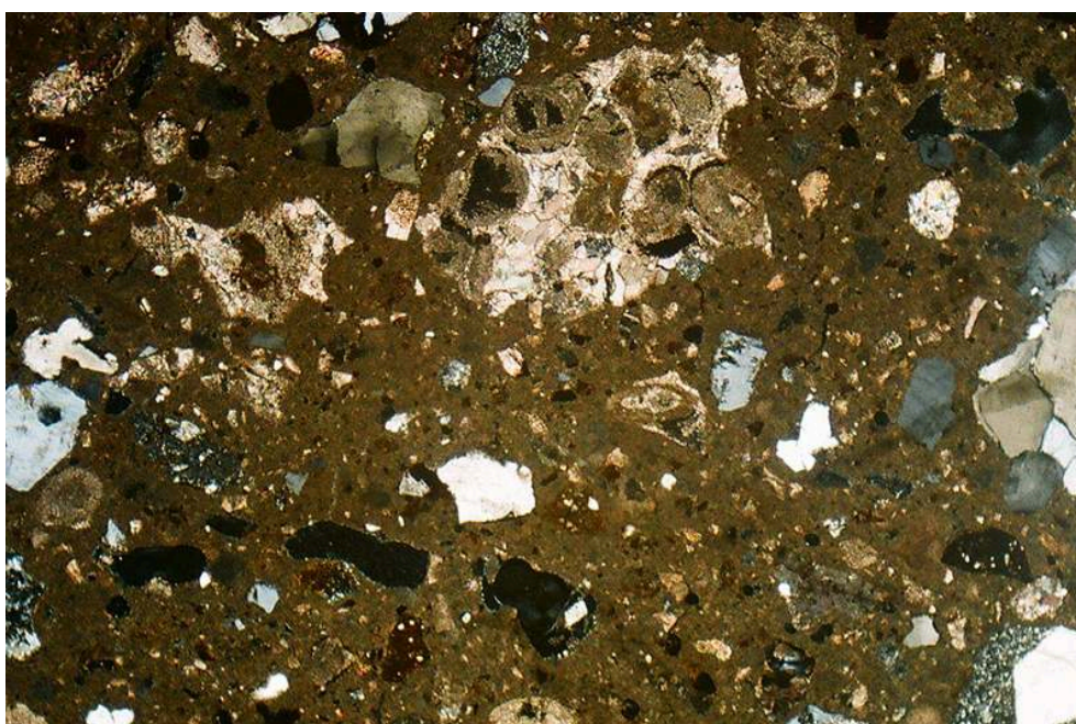
CLU 22-075 K (optique x 2), vue générale de l'enduit de support, en lumière naturelle et polarisée.
