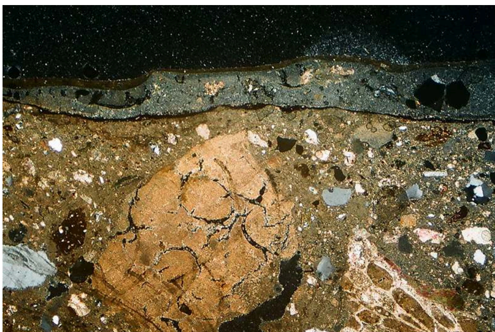
CLU 22-075 K (optique x 2), vue en coupe de la surface avec l'enduit lissé le badigeon blanc et la couche picturale, en lumière naturelle et polarisée.
