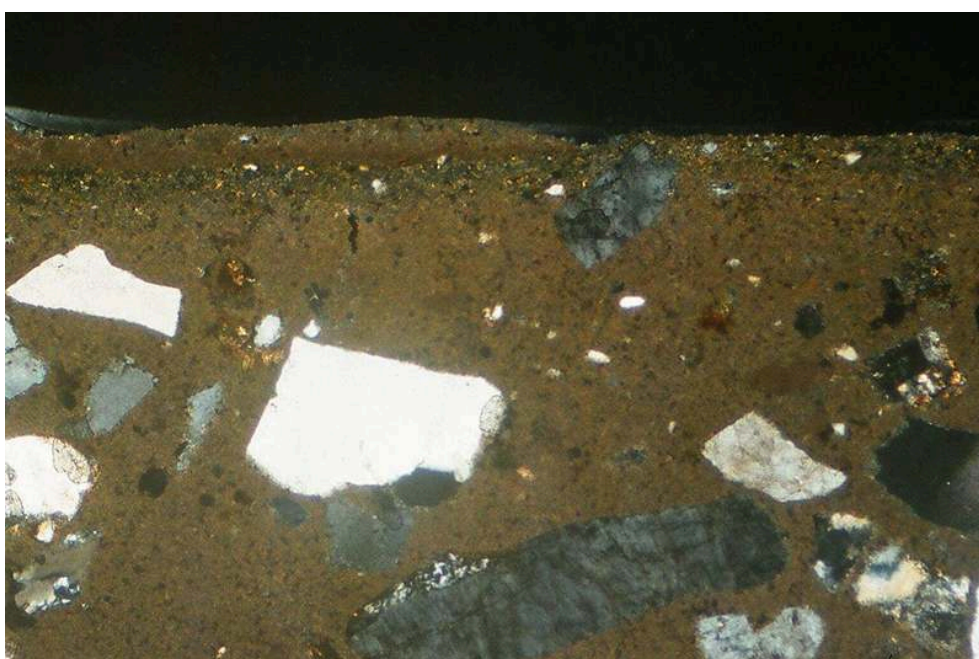
CLU 146-4 O (optique x 4), zoom en coupe du badigeon beige (bande horizontale plus claire en lumière naturelle) et du faux joint blanc rapporté dessus (surépaisseur plus foncée, marron en lumière naturelle).
