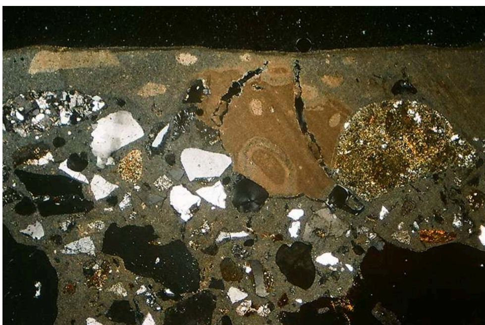
CLU 02-029 A (optique x 4), zoom sur l'enduit en coupe et le badigeon de surface, en lumière naturelle et polarisée.
