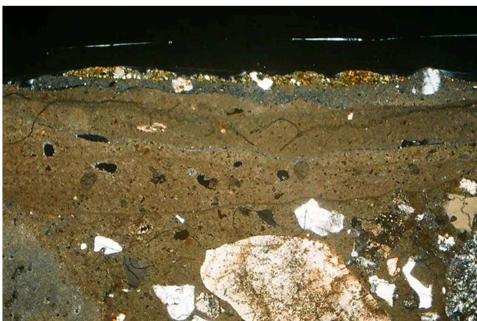
CLU 4-146 l' (prime) (optique x 2), vue de l'enduit en coupe avec sa superposition de badigeons et de couches picturales, en lumière naturelle et polarisée. On distingue 4 couches de surface, soit 3 badigeons de chaux, puis une couche picturale par-dessus, de couleur jaune, qui sera caractérisée au MEB.
