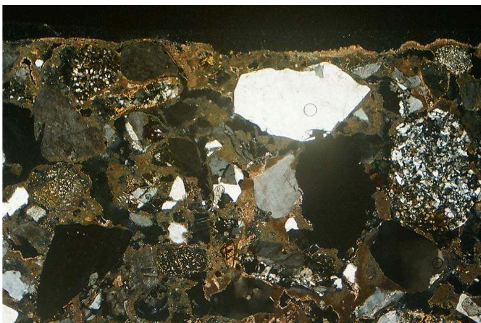
CLU 704-4 S (optique x 2), vue en coupe de l'enduit et de sa surface, en lumière naturelle et polarisée.
