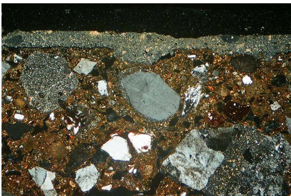
CLU 3-418 P (optique x 2), vue en coupe de l'enduit et de son badigeon blanc de chaux posé à la surface, en lumière naturelle et en lumière polarisée.
