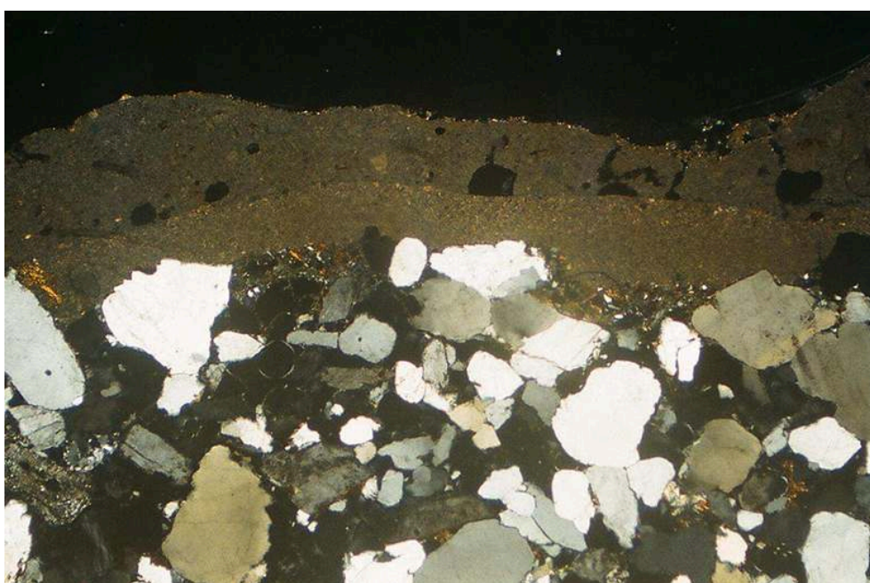
CLU 4-393 R (optique x 2), vue en coupe de l'échantillon (roche ?) recouvert de deux badigeons de chaux en surface, en lumière naturelle et polarisée.
