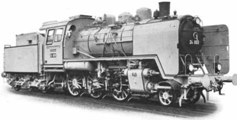
Abb. 11. 1'C Heißdampf-Zweizylinder-Verbund-Personenzuglokomotive, Reihe 24, Betriebsgattung P 34.15, gebaut von Borsig in Berlin.
