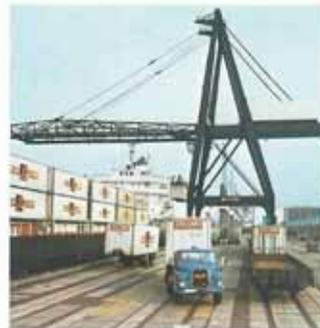
Container werden mit Kränen auf Sattelschlepper und Güterwagen verladen.
