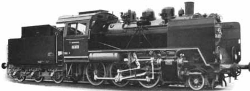
Abb. 12. 1'C Heißdampf-Zweizylinder-Personenzuglokomotive, Reihe 24, Betriebsgattung P 34.15, mit verstärkter Bremse und geschweißtem 17-m<sup>3</sup>-Tender, gebaut von Friedr. Krupp in Essen.
