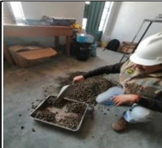
Imagen 09: separacion del agregado fino
