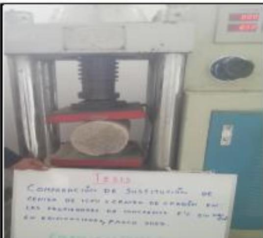
Imagen 51: rotura del de concreto a los 28 días del ensayo a la tracción
