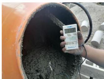
Figura 30. Concreto para la prueba de temperatura
