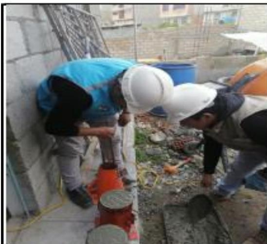
Imagen 31: ensayo del asentamiento cumpliendo con la norma técnica peruana
