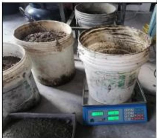
Imagen 24: cálculo de agua según el diseño de mezcla para las probetas
