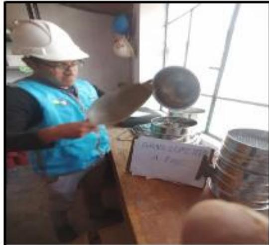
Imagen 10: analisis granulometrico del Agregado Fino
