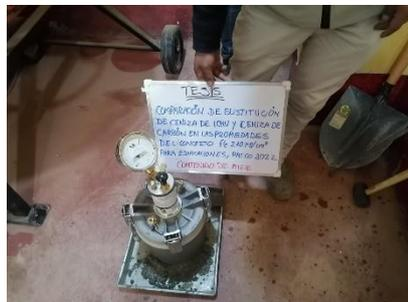
Figura 25.Resultado del ensayo de contenido de aire
