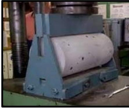
*Figura 11. Método para el cálculo de renuencia a la tracción.*
