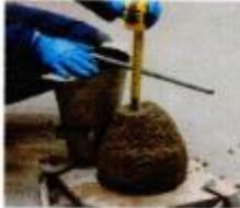
**Figura 01: Metodo para calcular el asentamiento**
