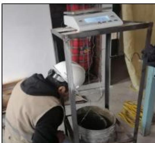
Imagen 18: peso del agregado saturado
