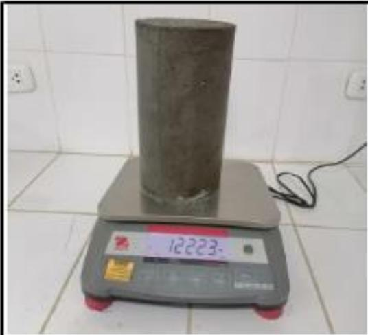
Imagen 43: cálculo de la probeta antes de la rotura
