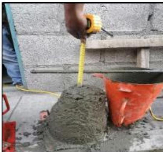
Imagen 32: calculo del asentamiento con el cono de abrams
