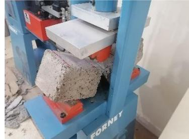
Figura 40. Ensayo de Renuencia a la flexión
