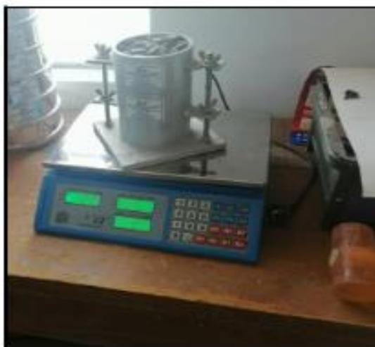
Imagen 16: peso del agregado para el ensayo
