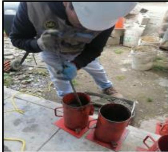
Imagen 38: apisonado del concreto fresco para las muestras del concreto
