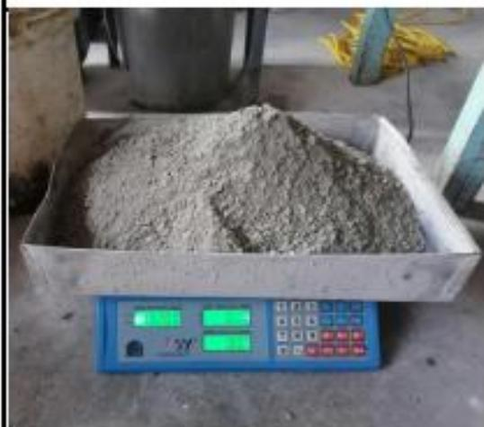
Imagen 23: cálculo de cemento según el diseño de mezcla para las probetas
