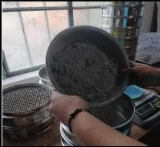
Imagen 07: preparacion para el tamizado de ceniza hasta la malla #100
