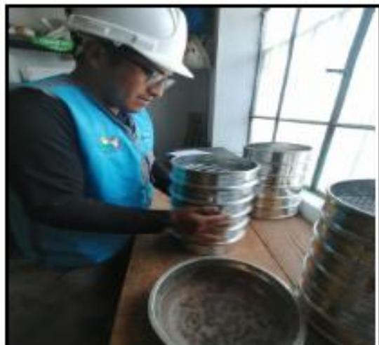
Imagen 12: agitado del agregado en el tamiz
