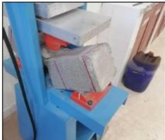
Imagen 54: rotura de la viga de concreto a los 28 días del ensayo a la flexión
