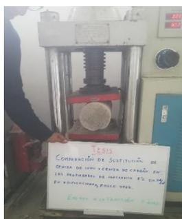
Figura 36. Ensayo de Resistencia a la tracción
