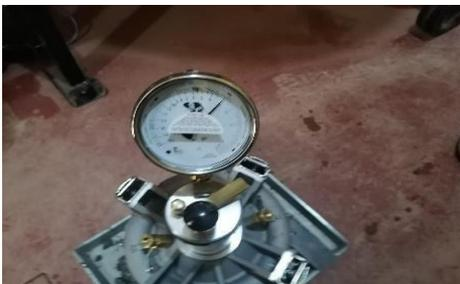
Figura 24.. Concreto para el contenido de aire
