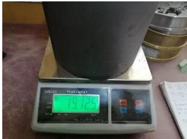
Figura 27. Concreto para la prueba de peso unitario
