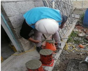
*Figura 21. Concreto para el ensayo de trabajabilidad*
