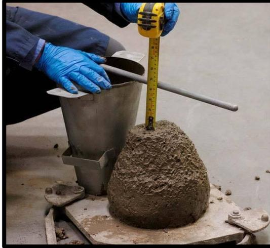
*Figura 13. Método para evaluar el asentamiento*
