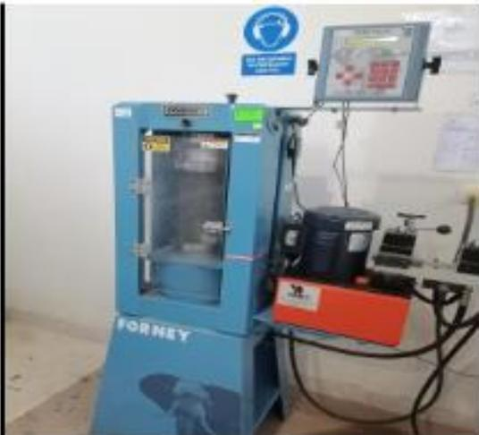
Imagen 45: rotura del concreto a los 7 días
