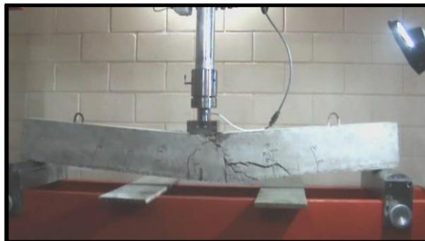
*Figura 12. Método para el cálculo de resistencia a la flexión.*
