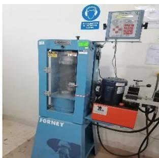
Figura 33. pruebas de Resistencia a la compresión
