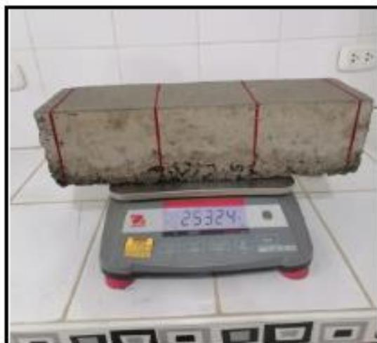
Imagen 48: cálculo de peso del concreto en viga antes de su ensayo respectivo
