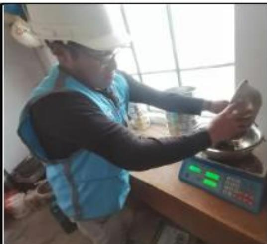
Imagen 11: pesando la cantidad de agregado
