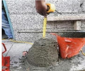
*Figura 22. Concreto para el ensayo de trabajabilidad*
