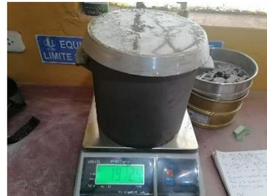
Figura 28. Resultado de la prueba de peso unitario
