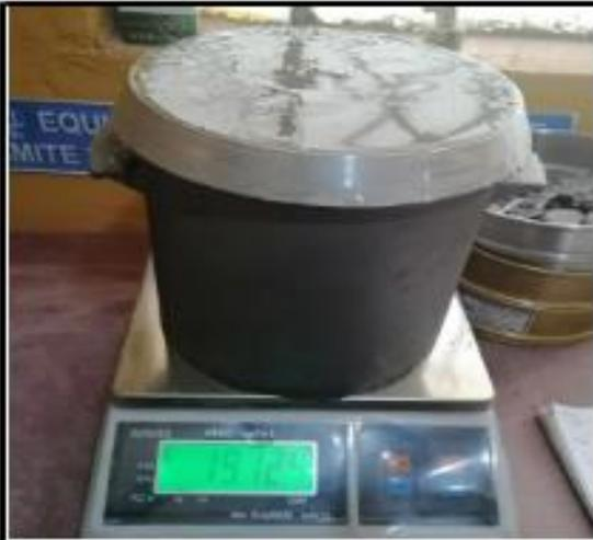
Imagen 37: peso específico del concreto fresco
