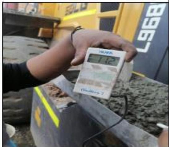
Imagen 30: toma de temperatura del concreto fresco
