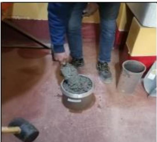
Imagen 33: ensayo del contenido de aire
