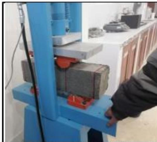
Imagen 52: rotura de la viga de concreto a los 7 días del ensayo a la flexión
