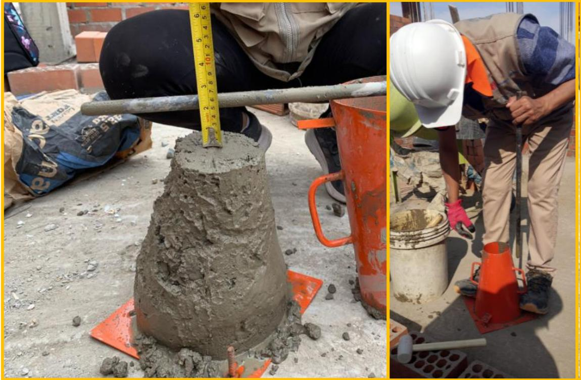
**COMENTARIO:** Y de igual forma se realizó la prueba de asentamiento antes de elaborar las probetas de concreto.
