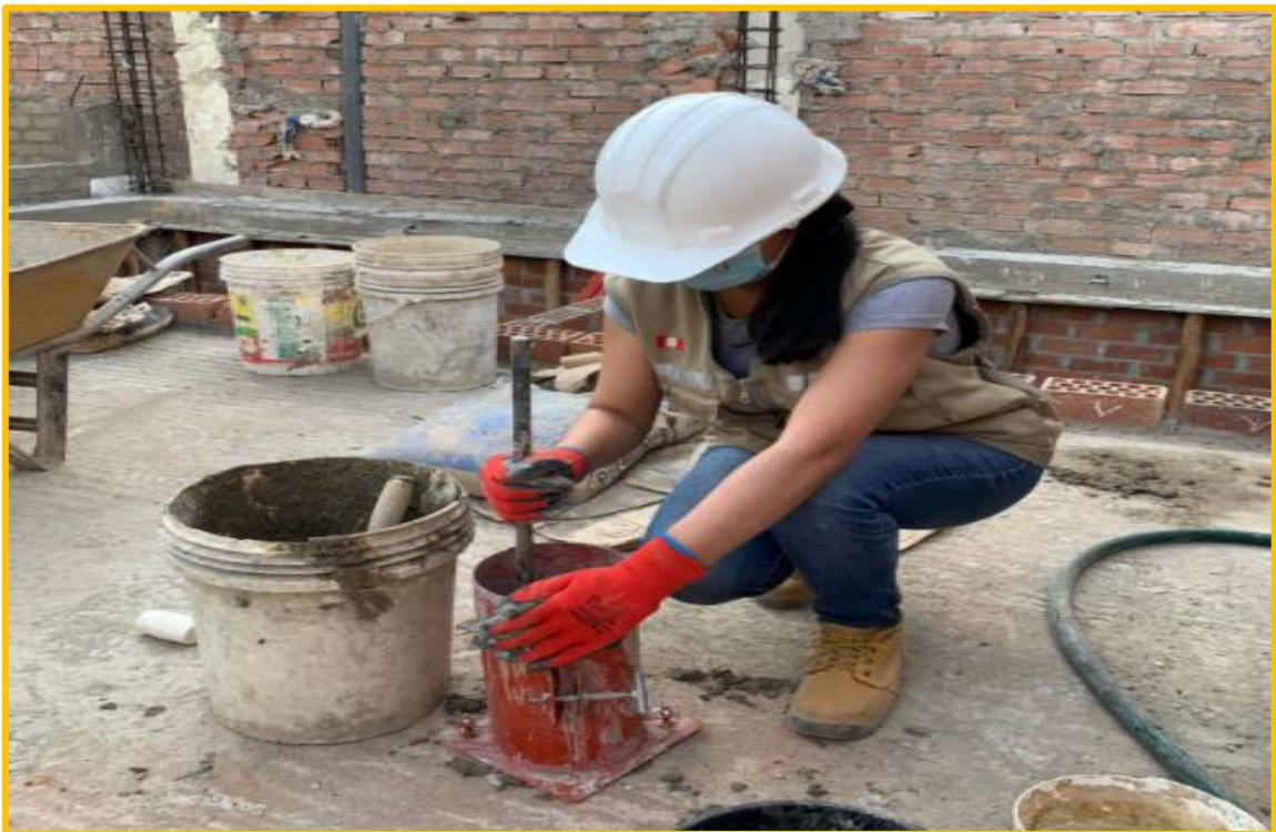
**COMENTARIO:** Se realizaron las probetas de concreto con adición de conchas de abanico trituradas al 1%, 2.5% y 5%.
