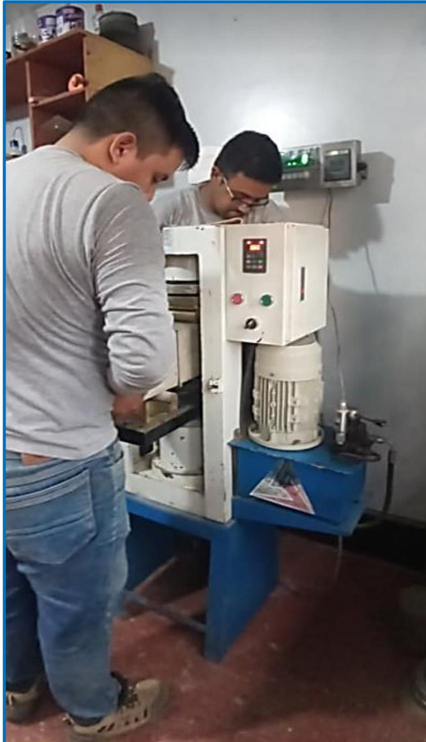
COMENTARIO: Se colocaron las vigas en la máquina de ensayo uniaxial, misma que se utilizó para los ensayos de resistencia a la compresión.
