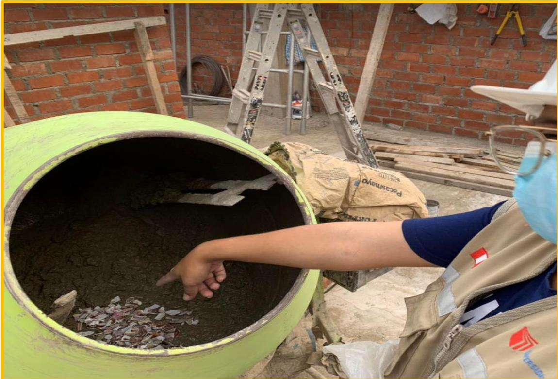
**COMENTARIO:** De la misma manera que para el concreto patrón, se realizó la mezcla para un concreto con adición de conchas de abanico para 1%, 2.5% y 5%.
