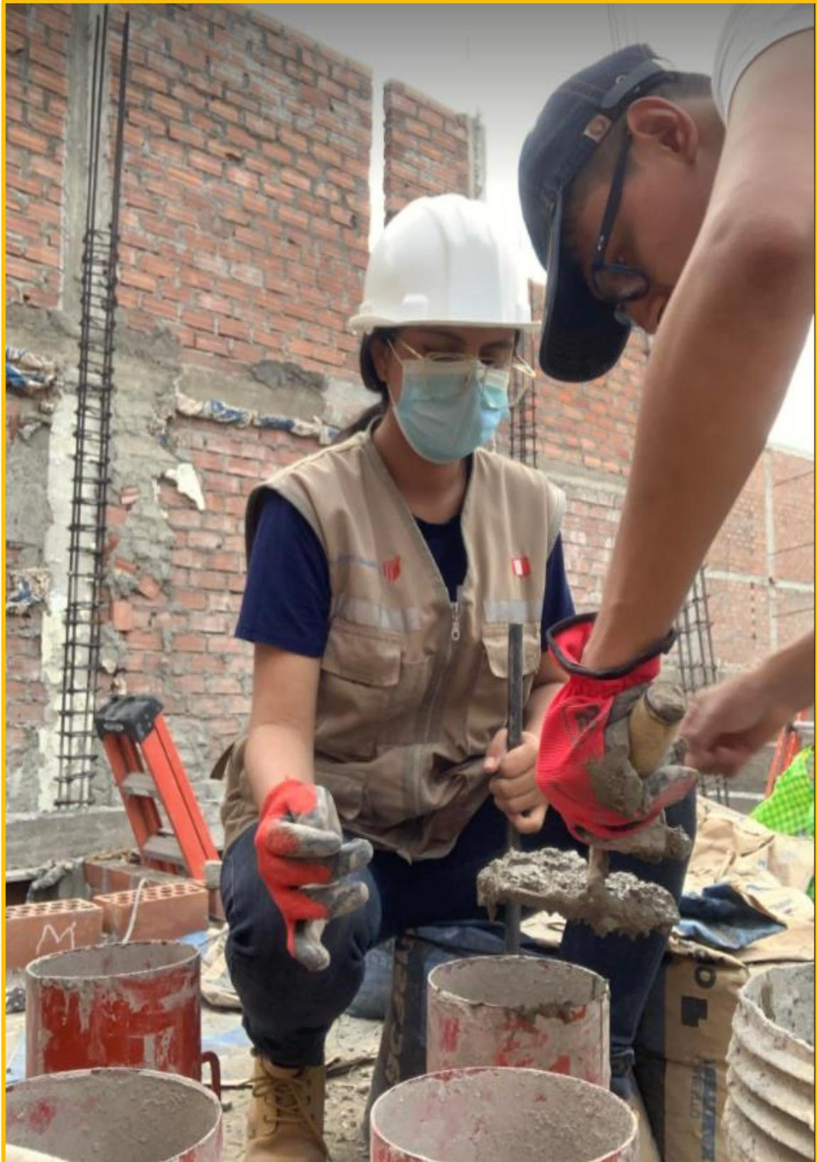
**COMENTARIO:** Posteriormente se procedió de elaborar las probetas de concreto, utilizando las debidas herramientas para facilitar la ejecución.
