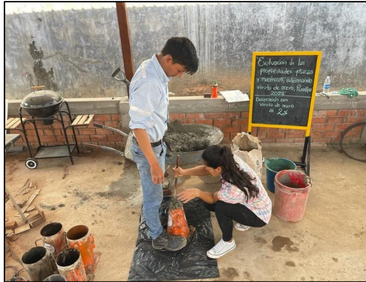
Figura 11. Prueba de slump (cono de Abrams) Fuente: propio de los autores
