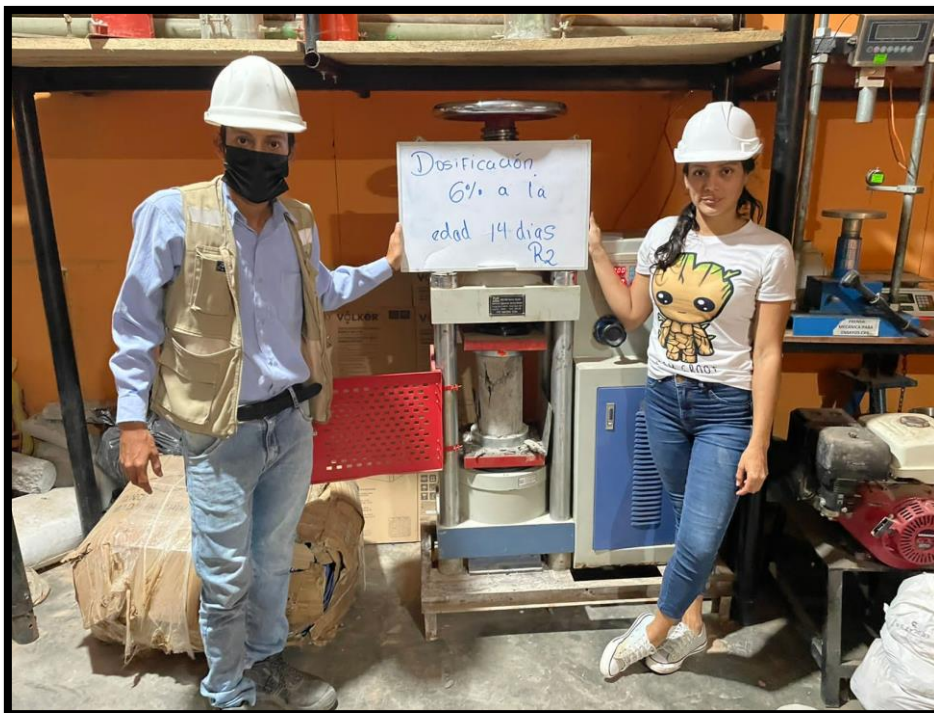
Foto N° 14 – Ensayo a compresión de probetas R2 al 6% a 14 días en laboratorio.
