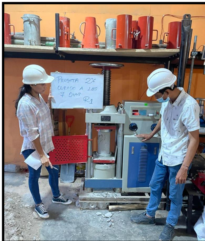
Foto N° 6 – Ensayo a compresión de probetas R1 al 2% a 7 días en laboratorio.
