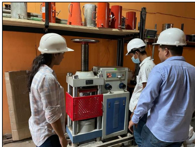
Figura 13. Rotura de probetas 1 Fuente: propio de los autores
