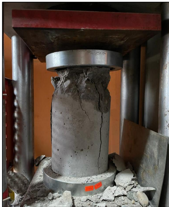
Figura 15. Probeta sometida a esfuerzo a compresión Fuente: propio de los autores
