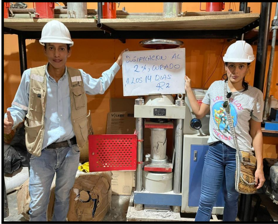
Foto N° 7 – Ensayo a compresión de probetas R2 al 2% a 14 días en laboratorio.
