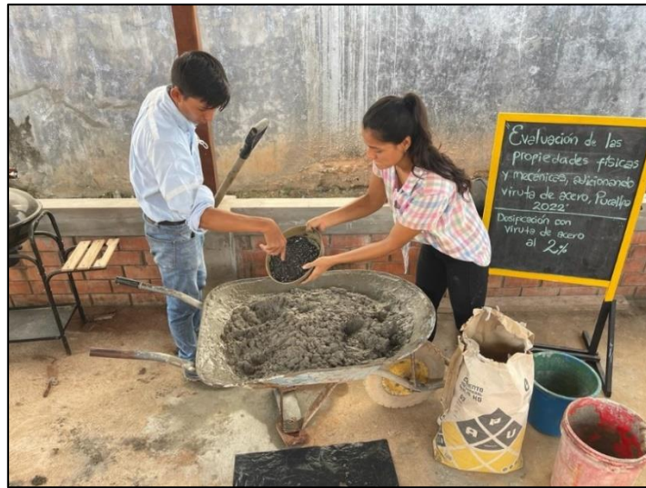
Figura 9. Adición de viruta de acero Fuente: propio de los autores
