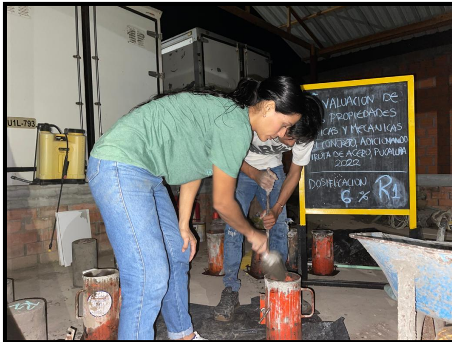
Foto N° 12 – Mezcla de los materiales para dosificación al 6% de viruta de acero
