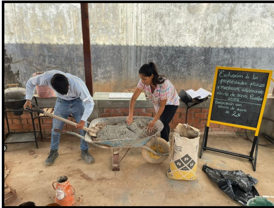
Foto N° 3 – Mezcla de los materiales para dosificación al 2% de viruta de acero.
