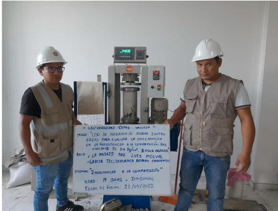
FOTOGRAFIA 27: Ensayo a compresión de testigos de concreto bajo la norma ASTM C39 de la muestra de concreto usando SIKADUR 32 del proyecto tesis: "Uso De Sikadur 32 Sobre Juntas Frías Para Evaluar La Incidencia En La Resistencia A La Compresión Del Concreto F' C 210 Kg/Cm2, Bagua Grande".
