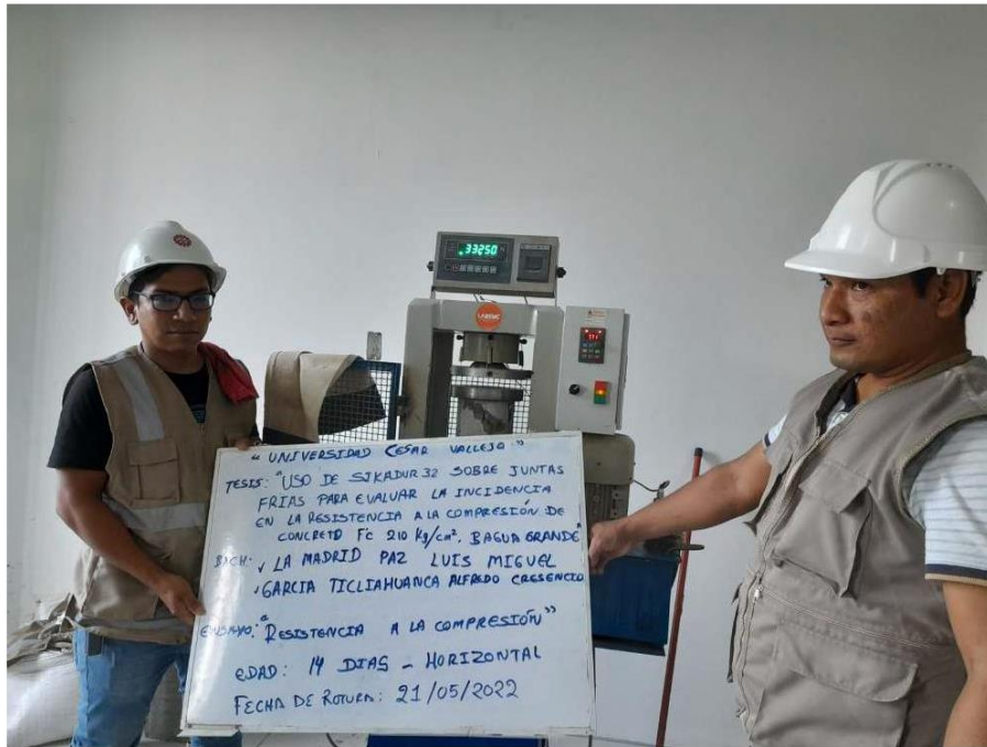
FOTOGRAFIA 10: Ensayo a compresión de testigos de concreto bajo la norma ASTM C39 de la muestra de concreto usando SIKADUR 32 del proyecto tesis: "Uso De Sikadur 32 Sobre Juntas Frías Para Evaluar La Incidencia En La Resistencia A La Compresión Del Concreto F' C 210 Kg/Cm2, Bagua Grande".
