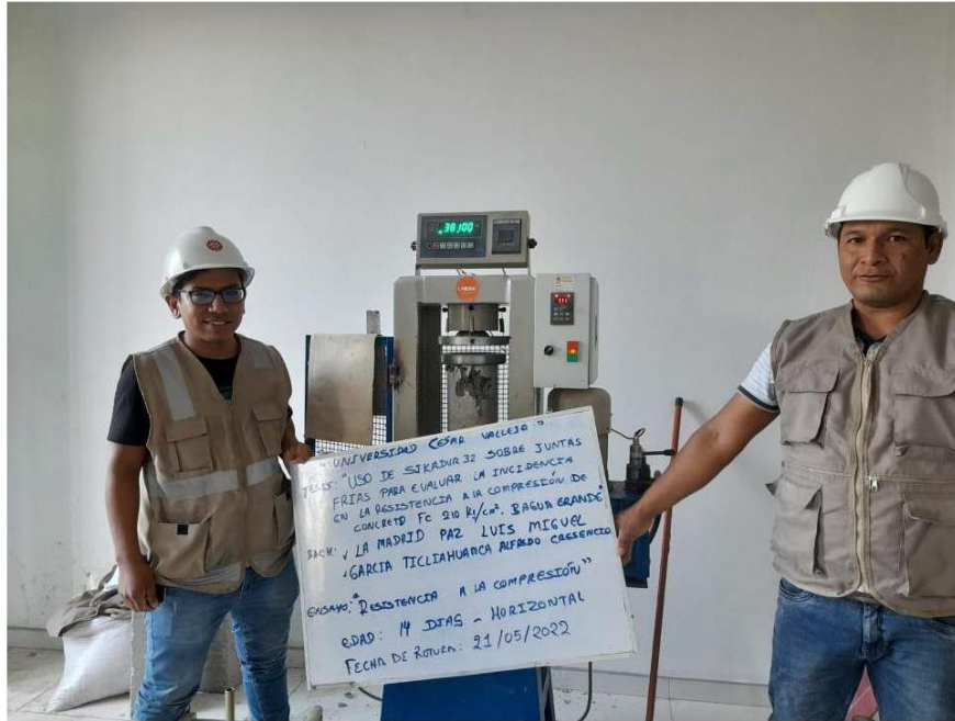
FOTOGRAFIA 09: Ensayo a compresión de testigos de concreto bajo la norma ASTM C39 de la muestra de concreto usando SIKADUR 32 del proyecto tesis: "Uso De Sikadur 32 Sobre Juntas Frías Para Evaluar La Incidencia En La Resistencia A La Compresión Del Concreto F' C 210 Kg/Cm2, Bagua Grande".V
