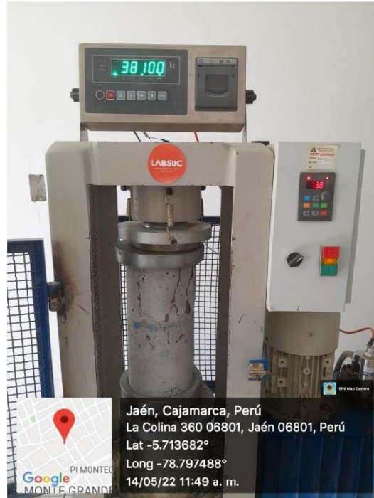
FOTOGRAFIA 03: Ensayo a compresión de testigos de concreto bajo la norma ASTM C39 de la muestra de concreto usando SIKADUR 32 del proyecto tesis: "Uso De Sikadur 32 Sobre Juntas Frías Para Evaluar La Incidencia En La Resistencia A La Compresión Del Concreto F´C 210 Kg/Cm2, Bagua Grande".
