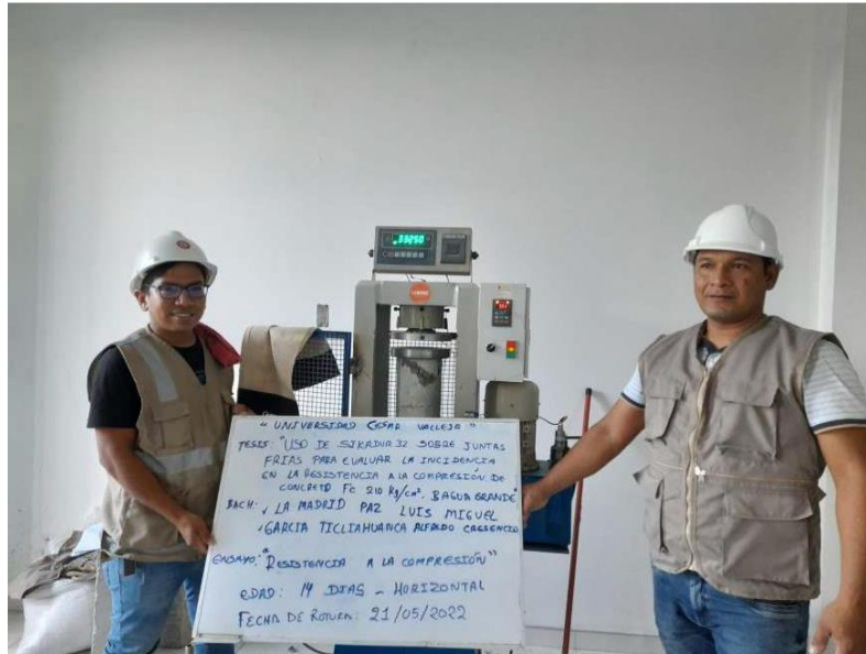
FOTOGRAFIA 08: Ensayo a compresión de testigos de concreto bajo la norma ASTM C39 de la muestra de concreto usando SIKADUR 32 del proyecto tesis: "Uso De Sikadur 32 Sobre Juntas Frías Para Evaluar La Incidencia En La Resistencia A La Compresión Del Concreto F' C 210 Kg/Cm2, Bagua Grande".
