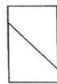
Tipo 4 Fractura diagonal sin fisuras a través de los extremos; golpee suavemente con un martillo para distinguirla del Tipo 1
