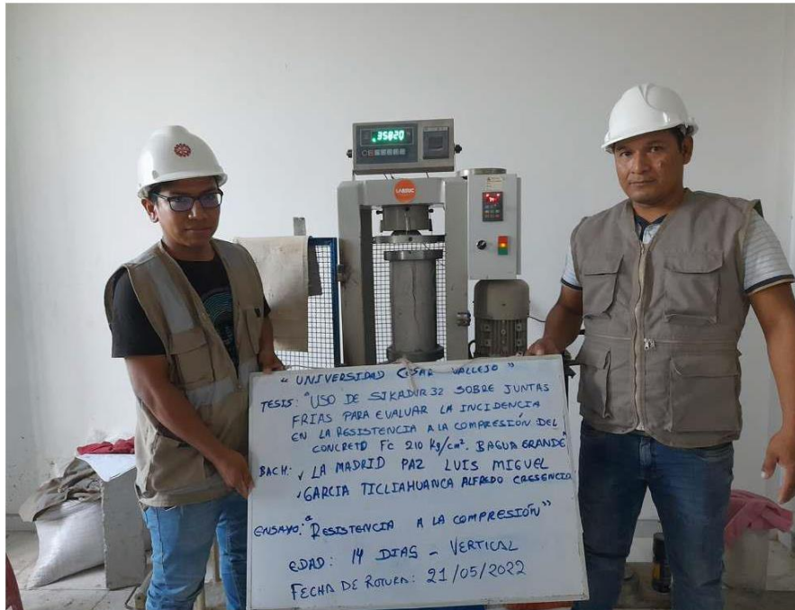
FOTOGRAFIA 22: Ensayo a compresión de testigos de concreto bajo la norma ASTM C39 de la muestra de concreto usando SIKADUR 32 del proyecto tesis: "Uso De Sikadur 32 Sobre Juntas Frías Para Evaluar La Incidencia En La Resistencia A La Compresión Del Concreto F' C 210 Kg/Cm2, Bagua Grande".
