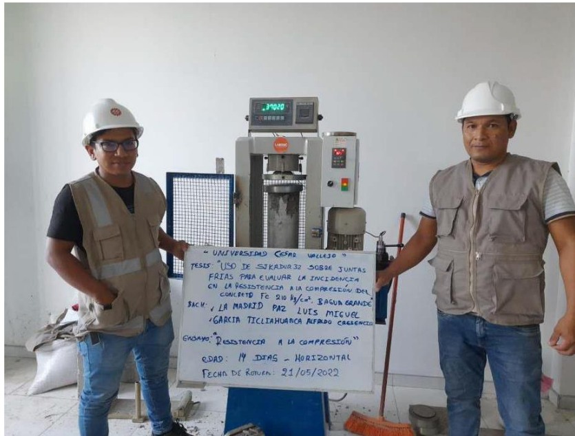
FOTOGRAFIA 07: Ensayo a compresión de testigos de concreto bajo la norma ASTM C39 de la muestra de concreto usando SIKADUR 32 del proyecto tesis: "Uso De Sikadur 32 Sobre Juntas Frías Para Evaluar La Incidencia En La Resistencia A La Compresión Del Concreto F´C 210 Kg/Cm2, Bagua Grande".
