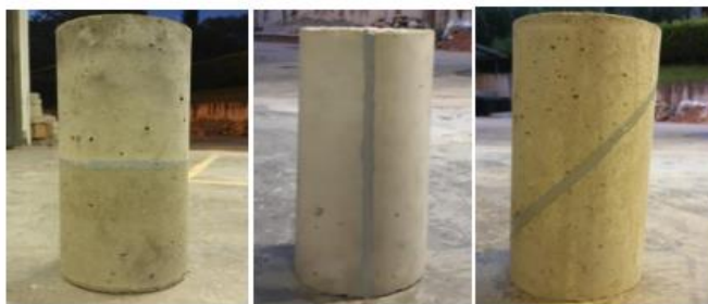
Figura 5. Probetas con aditivo epóxico en las juntas frías
