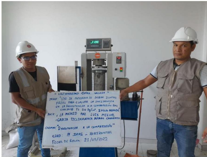
FOTOGRAFIA 06: Ensayo a compresión de testigos de concreto bajo la norma ASTM C39 de la muestra de concreto usando SIKADUR 32 del proyecto tesis: "Uso De Sikadur 32 Sobre Juntas Frías Para Evaluar La Incidencia En La Resistencia A La Compresión Del Concreto F' C 210 Kg/Cm2, Bagua Grande".
