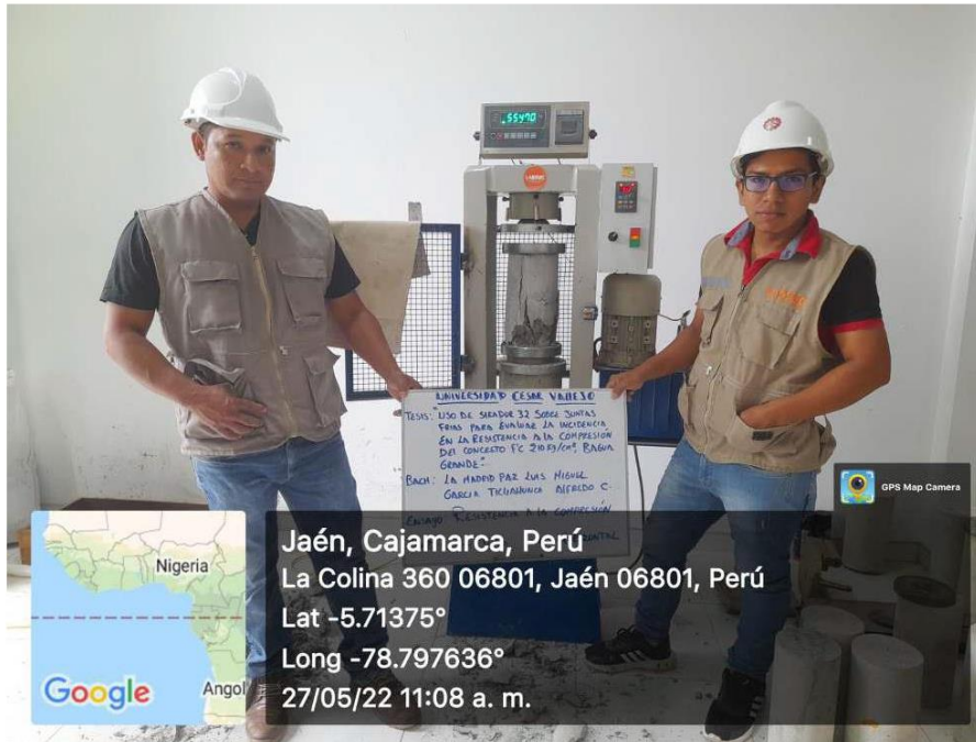
FOTOGRAFIA 17: Ensayo a compresión de testigos de concreto bajo la norma ASTM C39 de la muestra de concreto usando SIKADUR 32 del proyecto tesis: "Uso De Sikadur 32 Sobre Juntas Frías Para Evaluar La Incidencia En La Resistencia A La Compresión Del Concreto F' C 210 Kg/Cm2, Bagua Grande".
