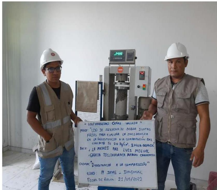
FOTOGRAFIA 28: Ensayo a compresión de testigos de concreto bajo la norma ASTM C39 de la muestra de concreto usando SIKADUR 32 del proyecto tesis: "Uso De Sikadur 32 Sobre Juntas Frías Para Evaluar La Incidencia En La Resistencia A La Compresión Del Concreto F' C 210 Kg/Cm2, Bagua Grande".
