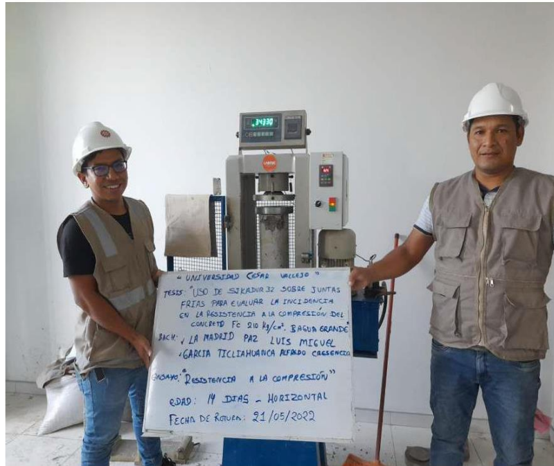
FOTOGRAFIA 05: Ensayo a compresión de testigos de concreto bajo la norma ASTM C39 de la muestra de concreto usando SIKADUR 32 del proyecto tesis: "Uso De Sikadur 32 Sobre Juntas Frías Para Evaluar La Incidencia En La Resistencia A La Compresión Del Concreto F' C 210 Kg/Cm2, Bagua Grande".
