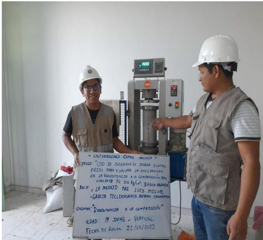
FOTOGRAFIA 23: Ensayo a compresión de testigos de concreto bajo la norma ASTM C39 de la muestra de concreto usando SIKADUR 32 del proyecto tesis: "Uso De Sikadur 32 Sobre Juntas Frías Para Evaluar La Incidencia En La Resistencia A La Compresión Del Concreto F' C 210 Kg/Cm2, Bagua Grande".
