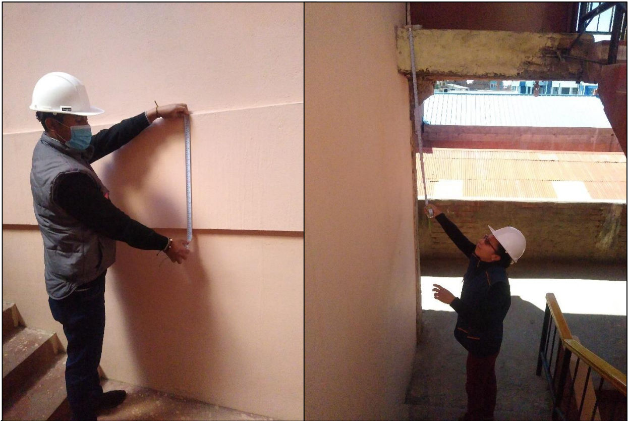
Fotografía realizando la medición de las vigas en distintos niveles para comparar con los planos obtenidos.
