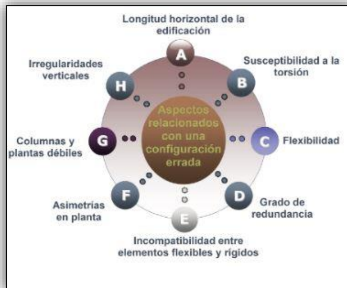
Figura 13. Aspectos relacionados con una configuración errada.
