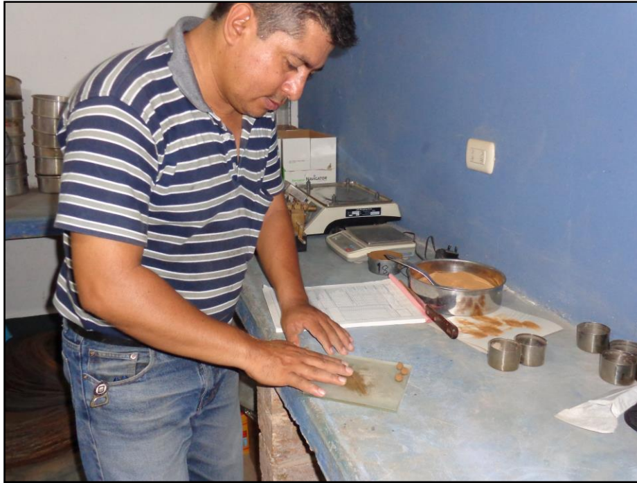
Foto N° 13.- Tesista realizando el ensayo de Límite Plástico
