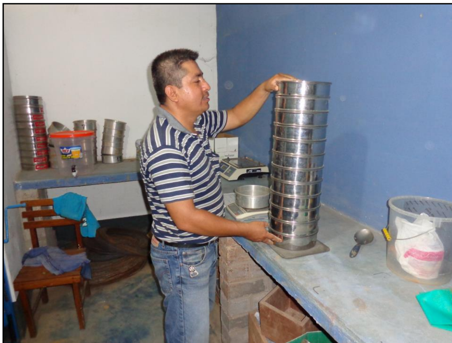
Foto N° 14.- Tesista realizando el ensayo Granulométrico
