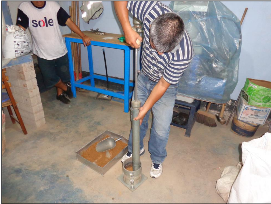
Foto N° 09.- Tesista realizando el ensayo de Compactación (Proctor Modificado)
