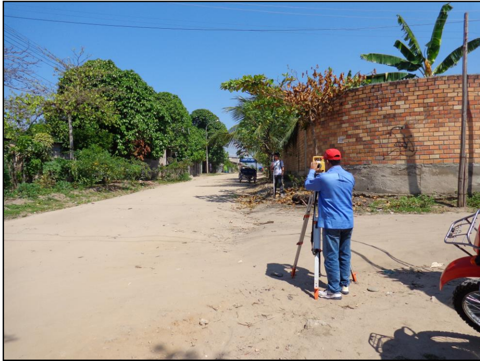
Foto N° 01.- Tesista realizando el levantamiento topográfico de la zona en estudio
