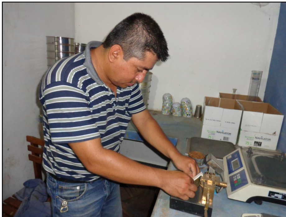
Foto N° 12.- Tesista realizando el ensayo de Límite Líquido
