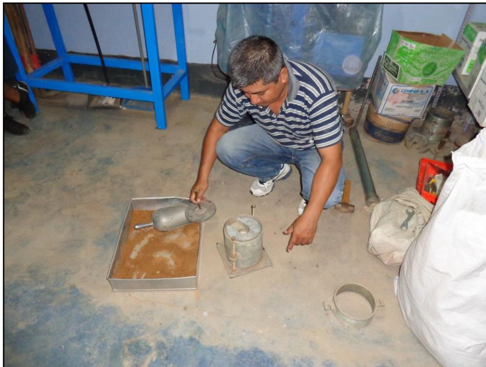
Foto N° 10.- Tesista realizando el ensayo de CBR
