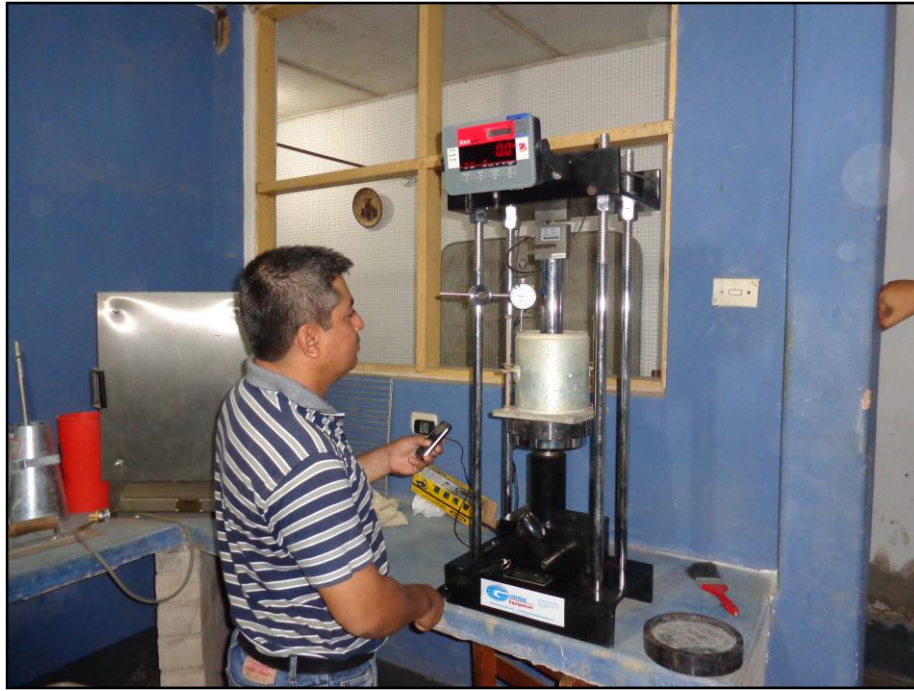
Foto N° 11.- Tesista sometiendo a carga los Moldes de CBR
