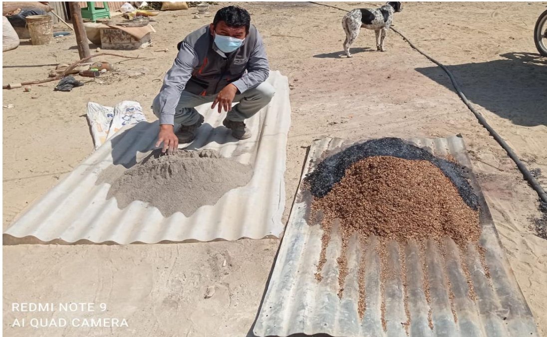
Figura n°03: Obtención de Ceniza de cascara de café.
