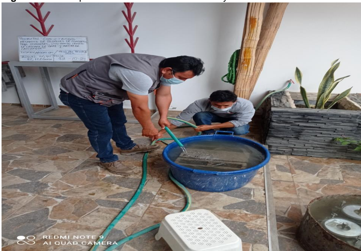
Figura n°08: Bloque de concreto sometido al ensayo de absorción.
