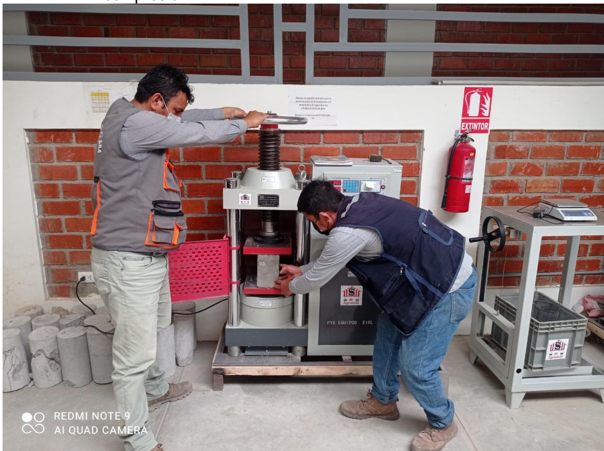
Figura n°07: Bloque de concreto sometido al ensayo de resistencia a la compresión.
