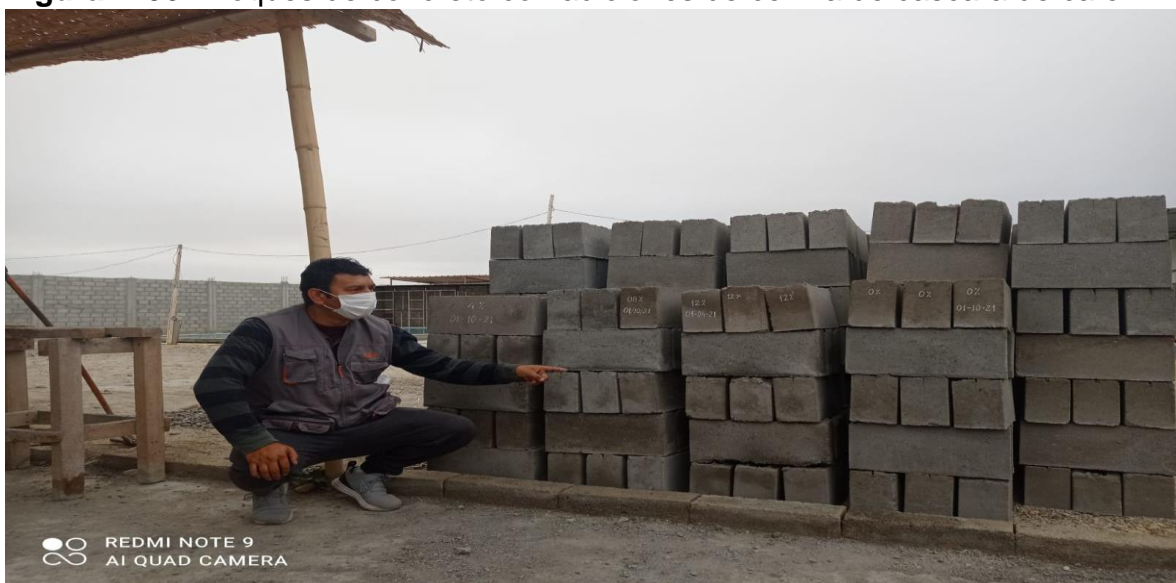
Figura n°06: Bloques de concreto con adiciones de ceniza de cascara de café.
