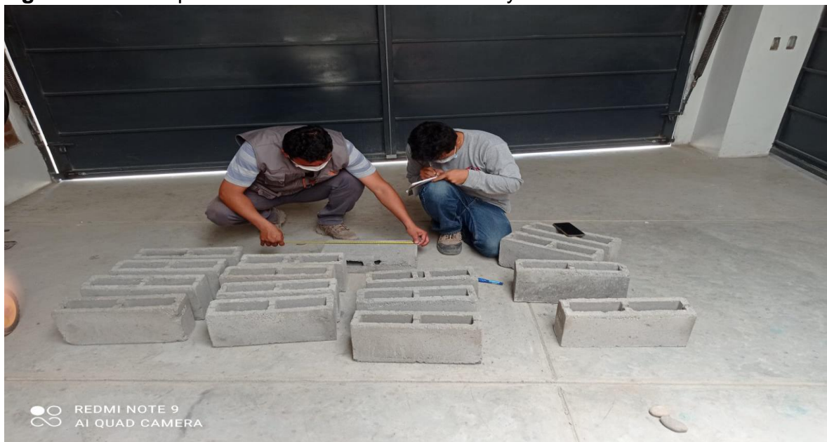
Figura n°11: Bloque de concreto sometido al ensayo de variación dimensional.
