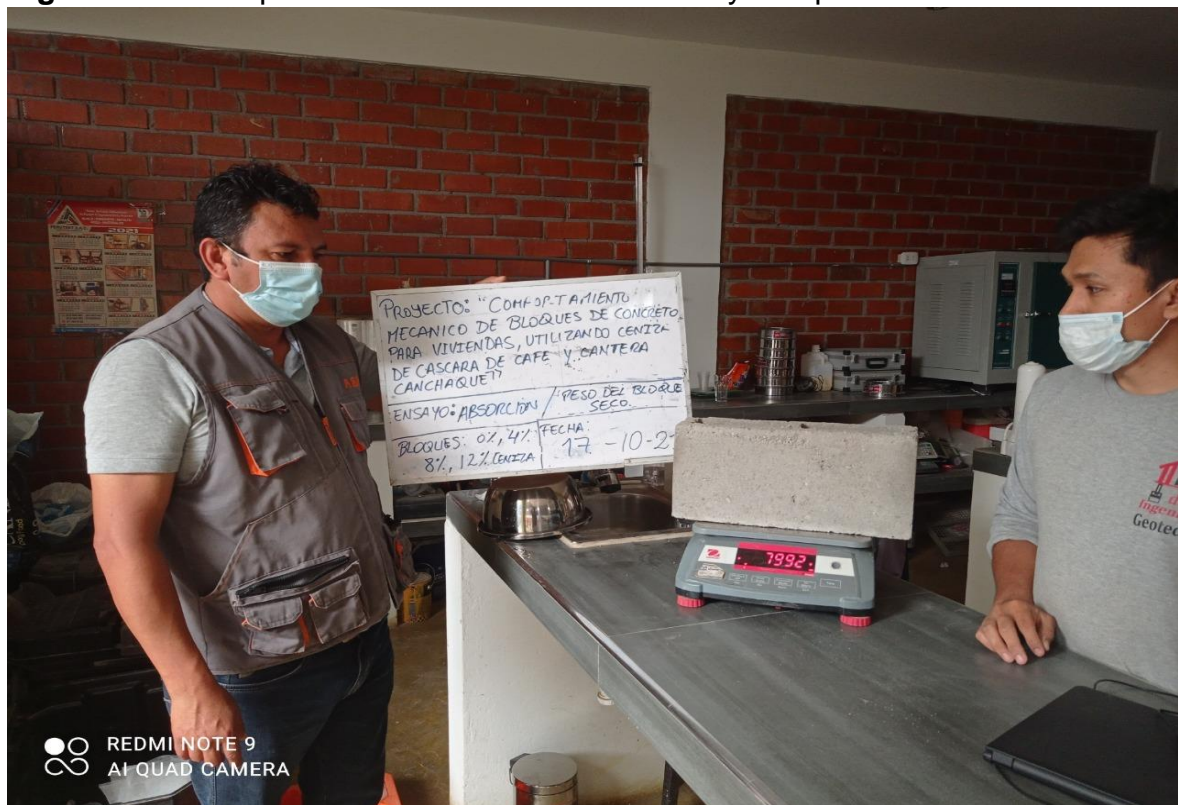
Figura n°09: Bloque de concreto sometido al ensayo de peso unitario.
