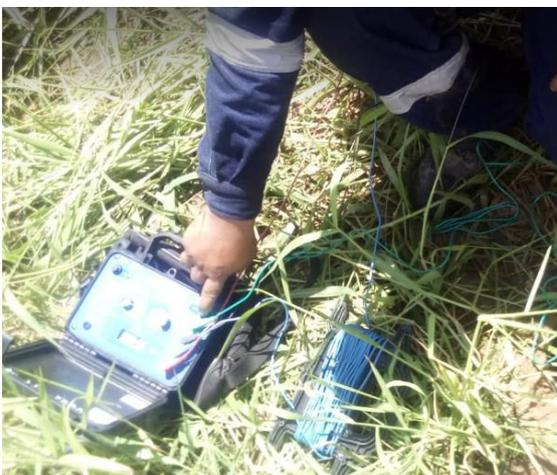
Figura 14: Resistividad con 2 metros de distancias entre electrodos.
