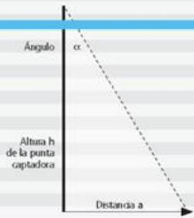
Figura 13: Tabla de ángulo para calcular el nivel de protección de pararrayos.
