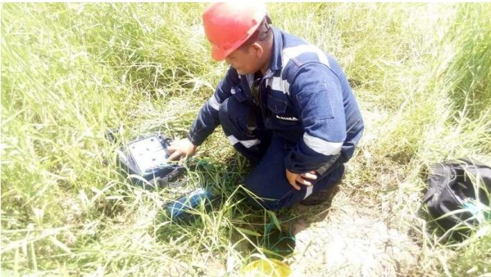
Figura 15 : Resistividad con 8 metros de distancias entre electrodos.
