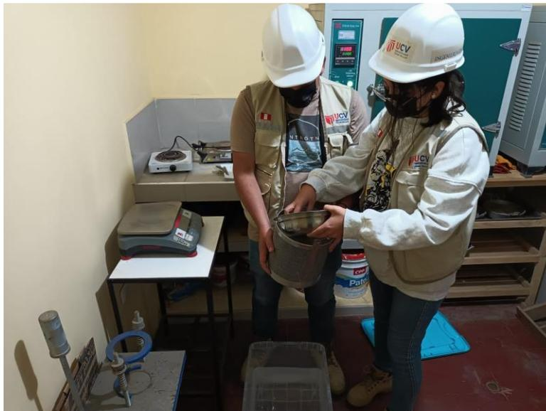
Proceso para determinar la gravedad especifica de los agregados gruesos.
