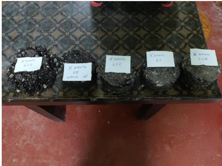
Obtención del optimo contenido de asfalto siendo 6%.
