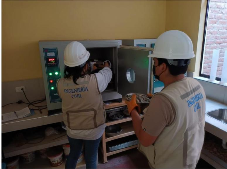
Secado de la muestra a temperatura  $110^{\circ} \pm 5$  por 24 horas.
