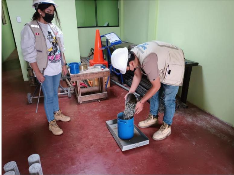
Agregado de material para peso unitario del agregado grueso.
