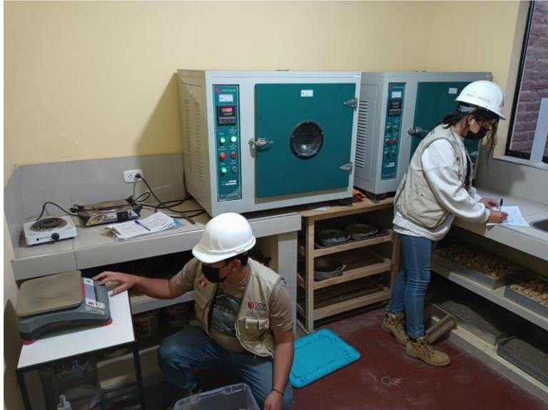
Proceso previo antes realizar la gravedad especifica de los agregados (tara).
