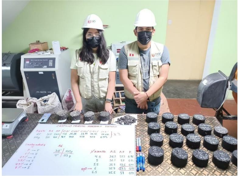
Briquetas control junto a briquetas patrón más caucho.
