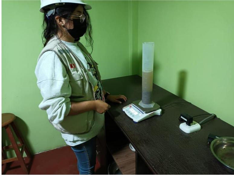
Proceso para determinar la gravedad especifica de los agregados finos.
