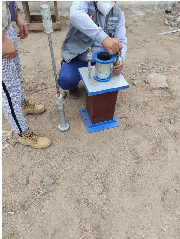
Preparación de molde para proceder con el ensayo de Marshall.
