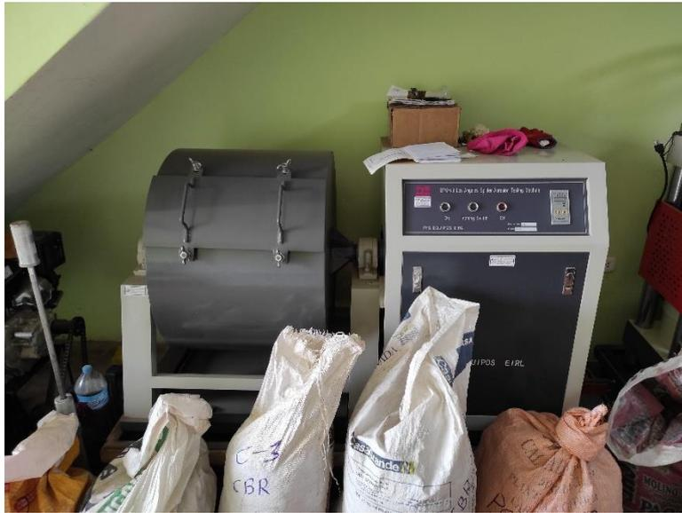
Máquina de los ángeles para realización de ensayo por abrasión.
