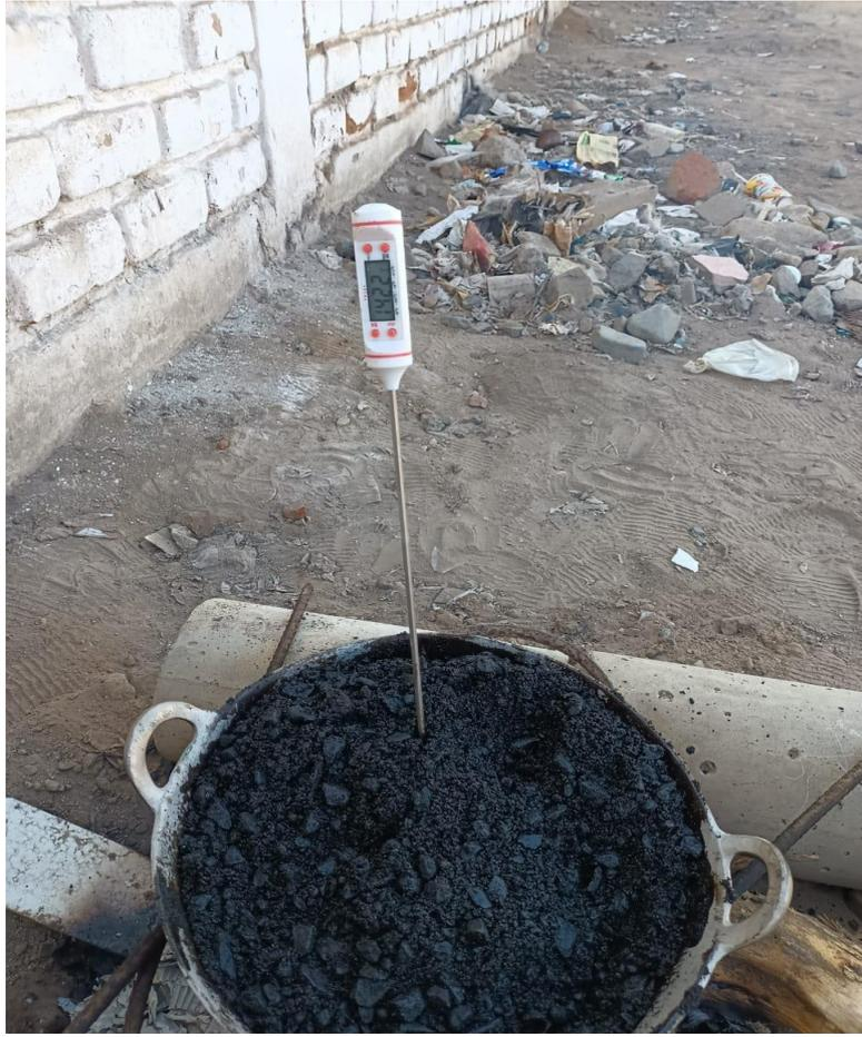
Verificación de temperatura a través de termómetro de precisión.
