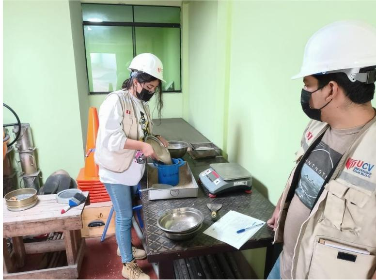
Agregado de material para peso unitario del agregado fino.
