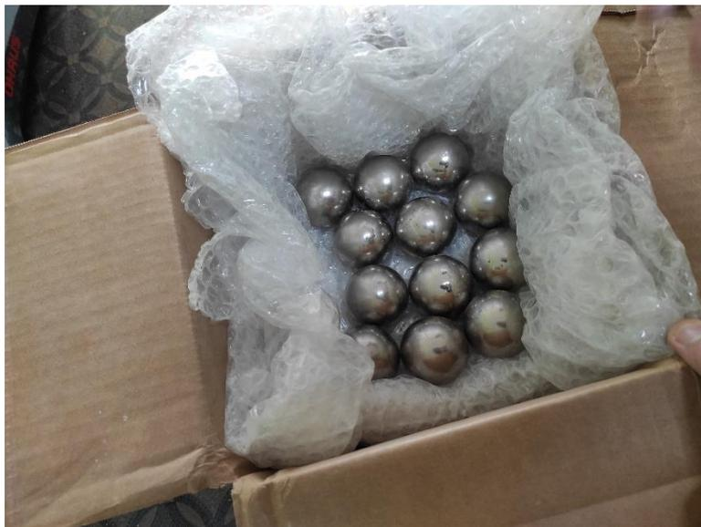
Esferas de acero para máquina de abrasión.
