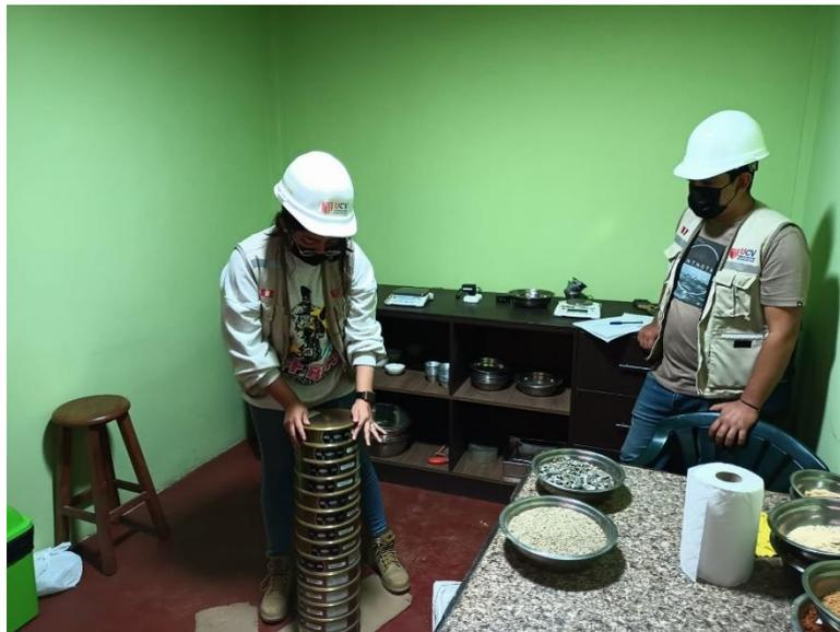
Agitación para el proceso de tamizaje para el ensayo granulométrico.
