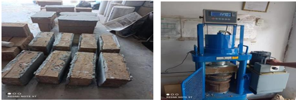
Figura 6. Ensayo de compresión de adobe
