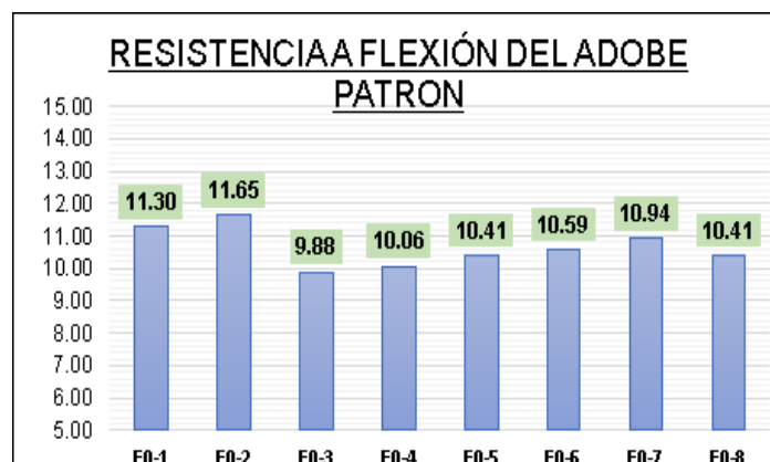
Figura 13. Ensayo de resistencia a flexión del adobe patrón
