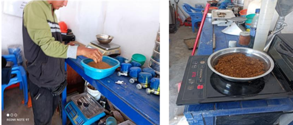
Figura 2. Ensayo de granulometría
