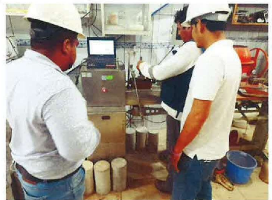
Supervision del ensayo de Corte Directo en laboratorio "Geotecnia E.I.R.L
