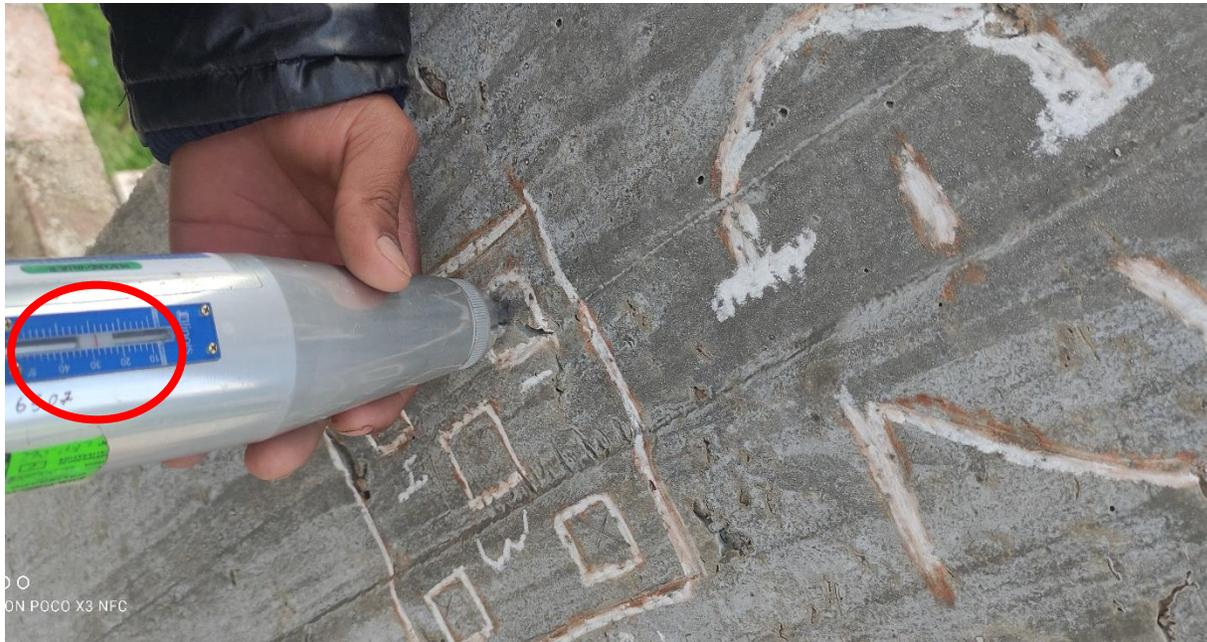
Figura N°10: fotografía de la utilización del esclerómetro en in situ.
