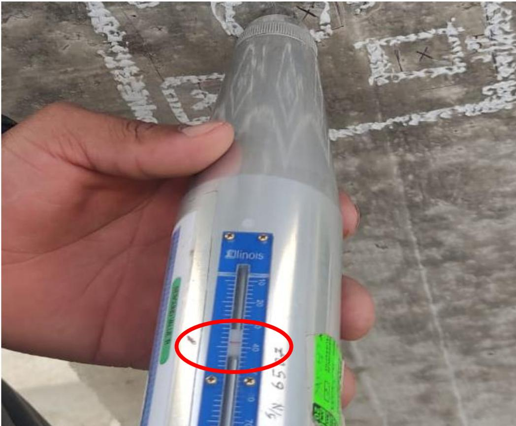
**Nota:** la imagen de fuente propia nos muestra el impacto N° 03 en el centro nos da una lectura de 38 tomada con el esclerómetro en columna revestido con plástico.
