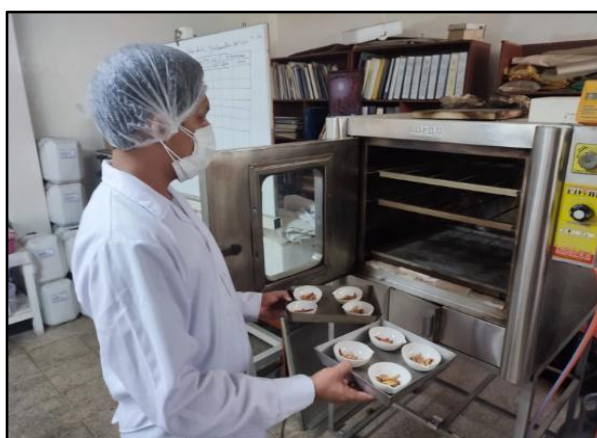
Figura 8 Medición de humedad
