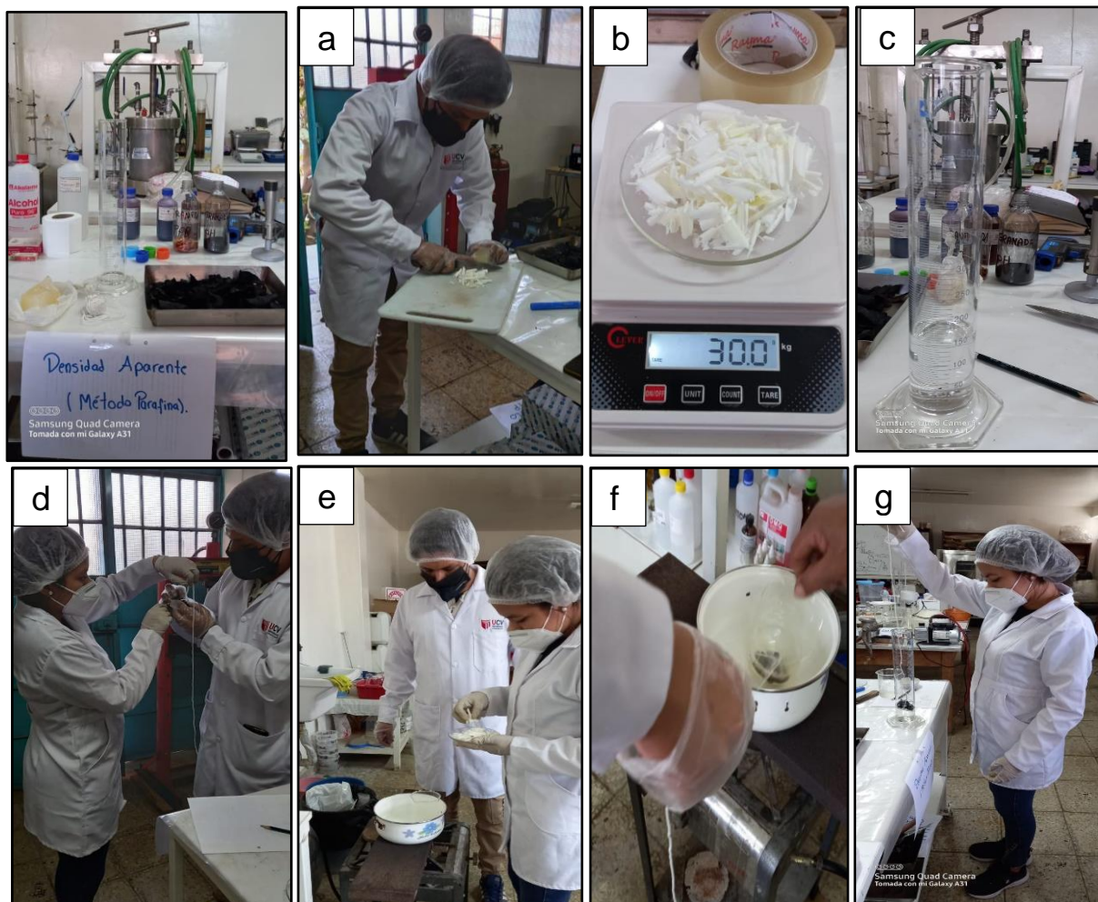
Figura 14 Densidad aparente, a) Cortado de parafina, b) Pesado, c) Volumen de la probeta, d) Amarrado de biocarbón, e) Baño maría, f) Empapado de parafina, g) Introducción de parafina en probeta
