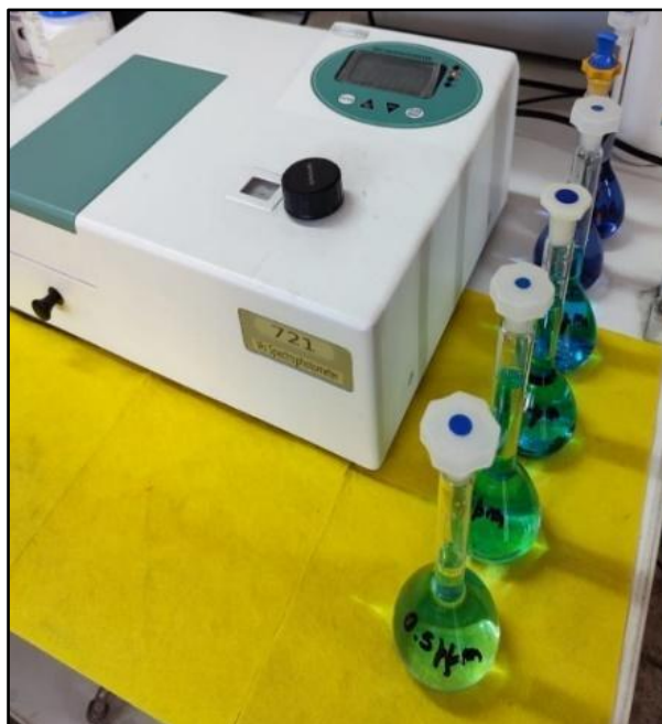
Figura 26 Método espectrofotetría UV/V del agua residual de azul de metileno
