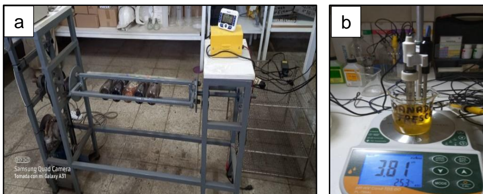
Figura 9 Medición de Potencial de hidrógeno, a) Equipo de rotación, b) pH de la cáscara de la granada fresca
