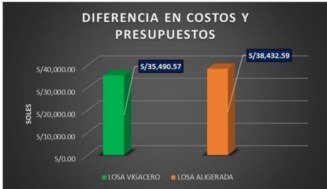
Figura 83: Cuadro de diferencia de los Costos de los Sistema de Losas.
