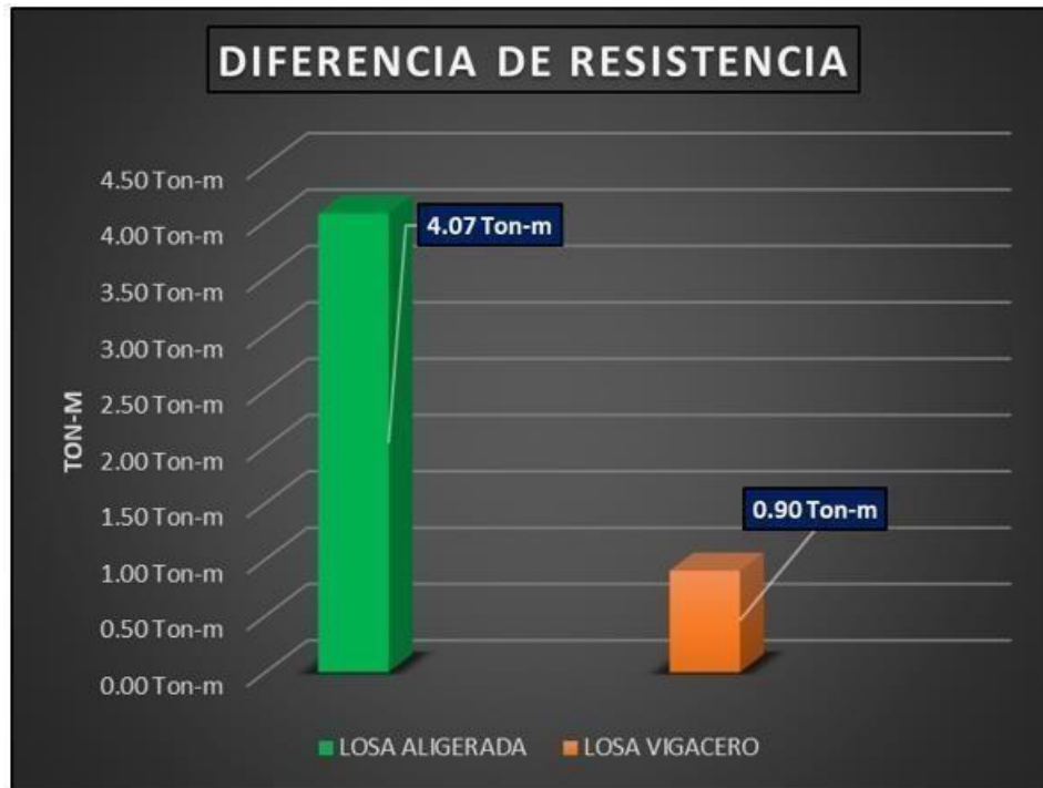
Figura 80: Cuadro de diferencia de resistencia de los Sistema de Losas.
