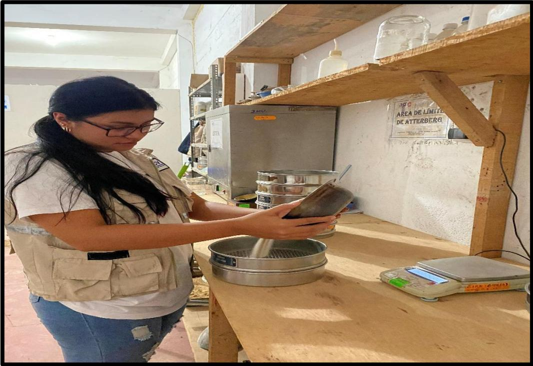
Anexo 40: Ensayos del peso específico
