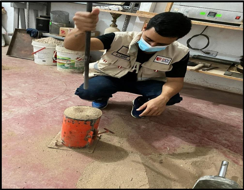
**Anexo 42:** Preparación de la mezcla para el bloque de concreto con PET reciclado con 3%, 7% y 15%
