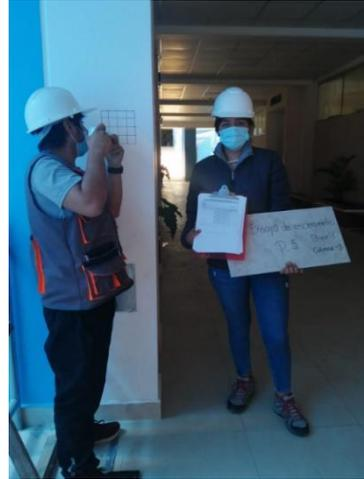
14. Realizando el ensayo de esclerómetro en C-2 (columna).
