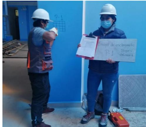
10. Realizando el ensayo de esclerómetro en C-1 (columna).
