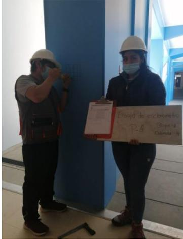
17. Realizando el ensayo de esclerómetro en C-4 (viga).
