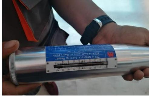
18. Esclerómetro (equipo)
