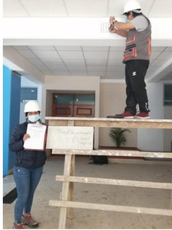
13. Realizando el ensayo de esclerómetro en V-2 (viga).
