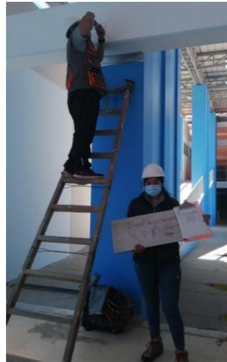
16. Realizando el ensayo de esclerómetro en V-4 (viga).
