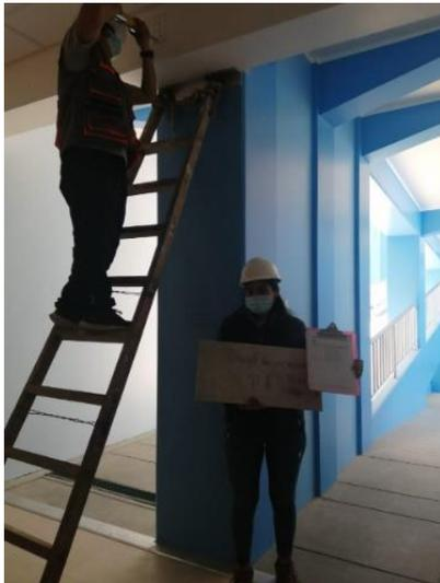
15. Realizando el ensayo de esclerómetro en V-3 (viga).
