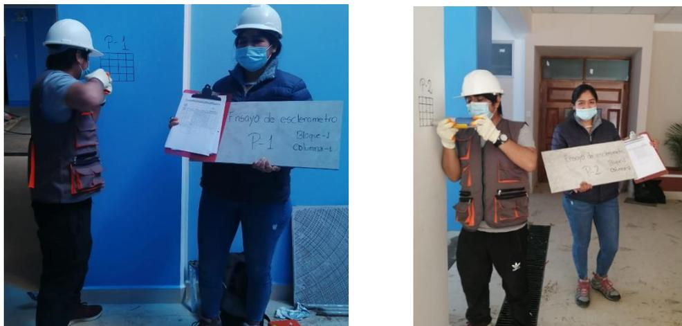
Figura 8. Reconocimiento de elementos estructurales (ensayo esclerómetro)
