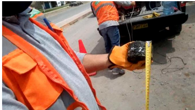
Figura 19. Segunda diamantina siendo medida luego de ser marcada como M-2 Fuente: Elaboración propia
