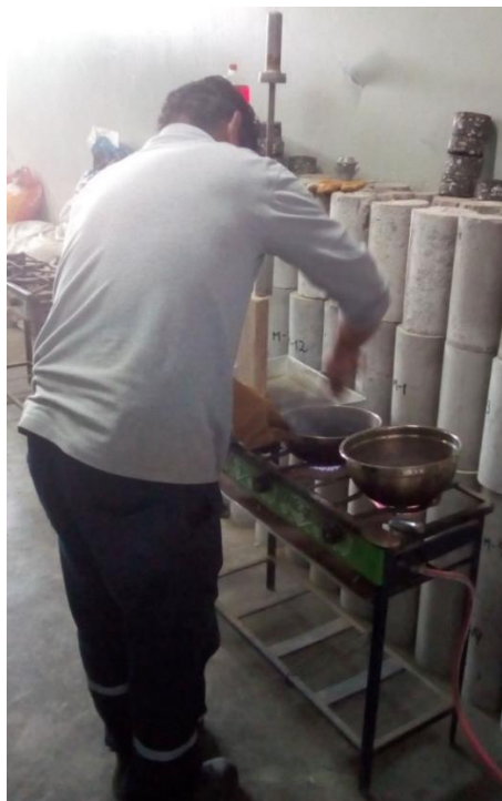
Figura 25. Calentando el material del pavimento asfáltico para armar briquetas Fuente: Elaboración propia
