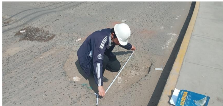
Figura 31. El investigador midiendo el diámetro del hueco.
