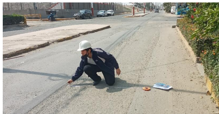
Figura 32. El investigador midiendo el ancho de la piel de cocodrilo.
