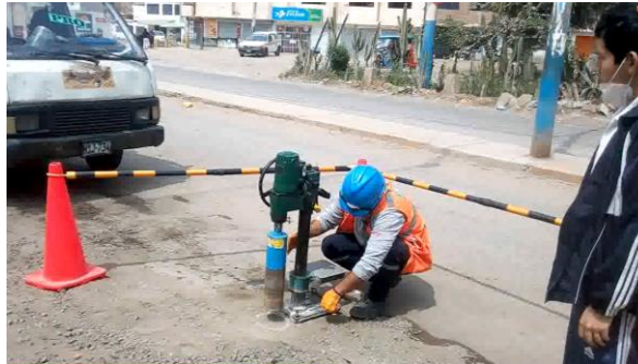
Figura 15. Investigador viendo al operario preparar el taladro de corte
