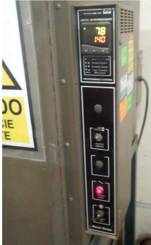
Figura 22. Horno a una temperatura de 140°C Fuente: Elaboración propia.
