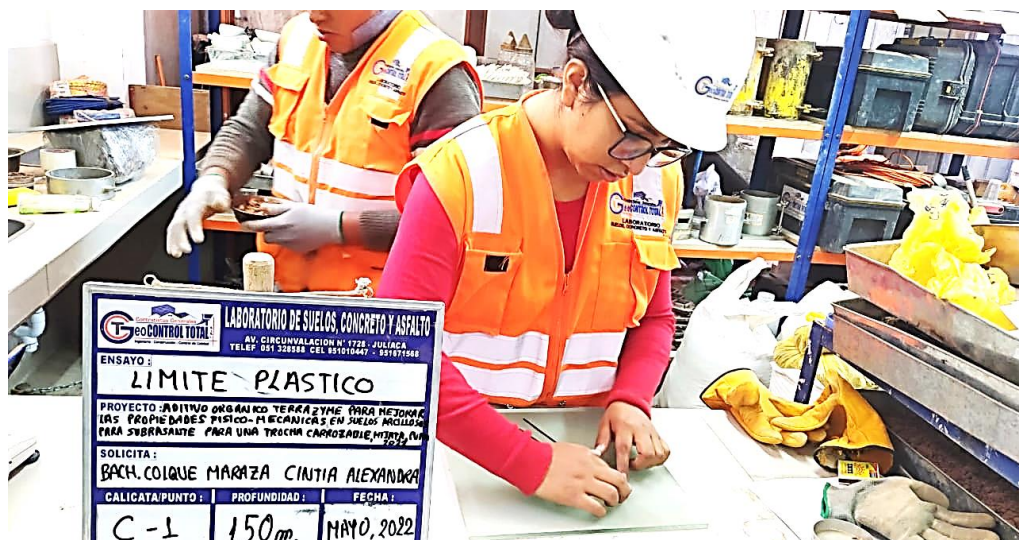
Figura 16. Ensayo de Limite Plástico.
