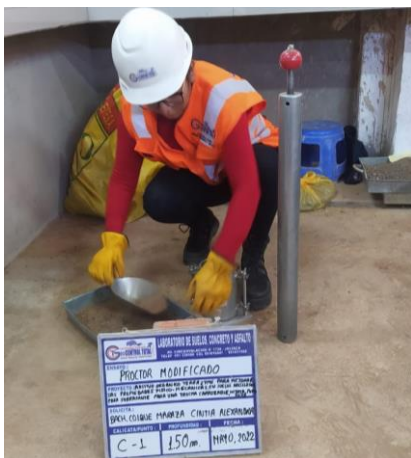
Fotografía 11. Ensayo Proctor modificado
