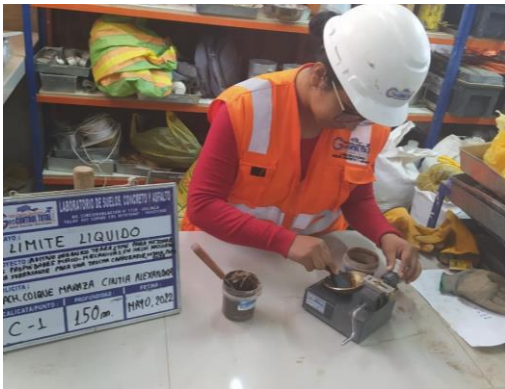
Fotografía 9. Ensayo de límites de consistencia.
