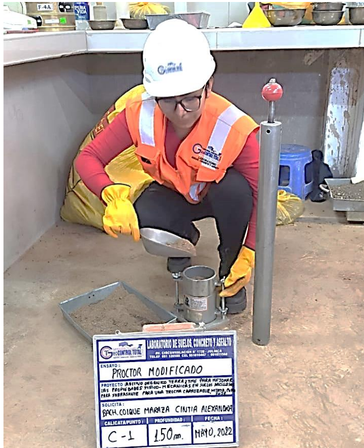
Figura 17. Ensayo Proctor Modificado.
