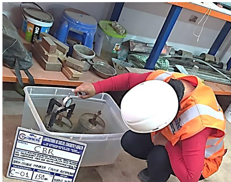
Figura 18. Ensayo CBR -etapa inmersión.
