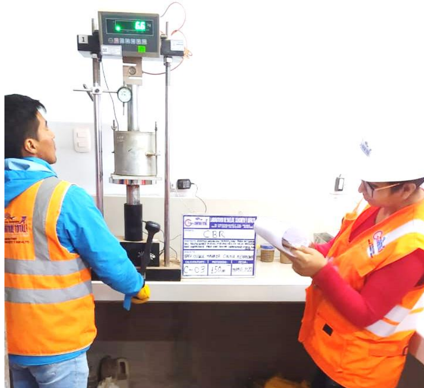
Figura 19. Ensayo CBR - Etapa penetración.
