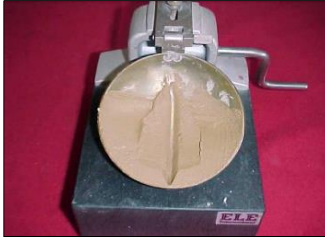
Figura 08: Cuchara de Casagrande
