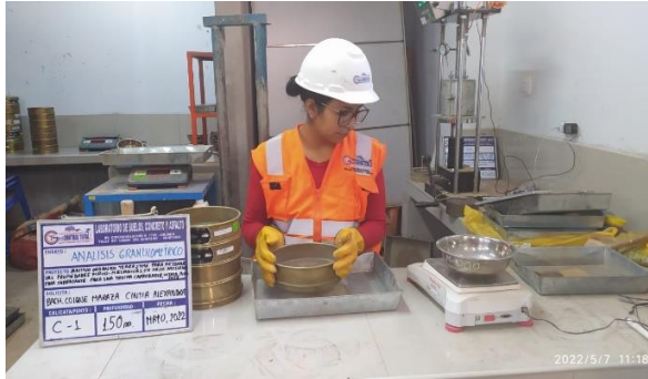
Fotografía 7. Ensayo de granulometría
