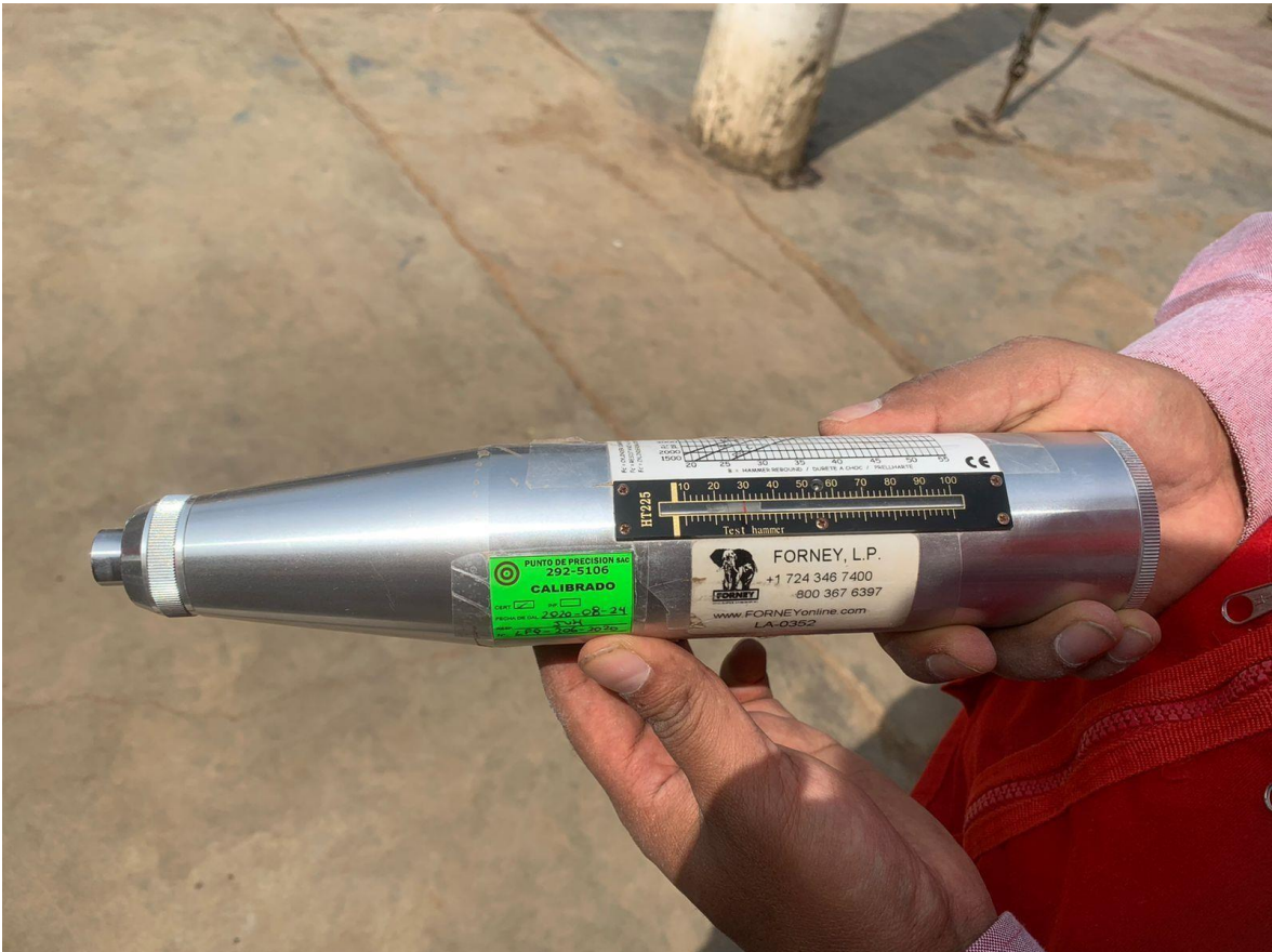
Figura 13: Esclerometro Fuente: elaboración propia
