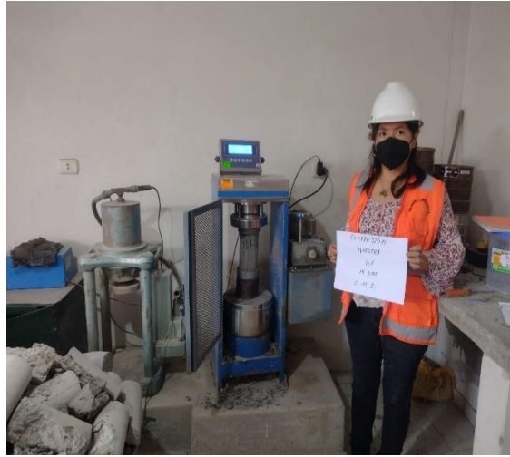
8. Realización de ensayo de compresión y rotura de probetas
