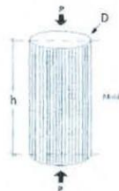
Tipo 3 Grietas verticales columnares en ambas bases, conos o bien formados
