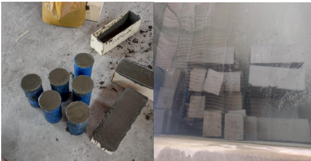
7. Encofrado y curado de probetas y prismas de concreto
