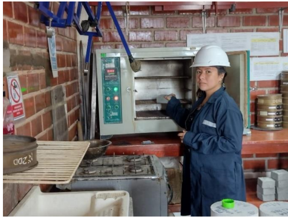
9. Realización de ensayo de absorción en concreto endurecido
