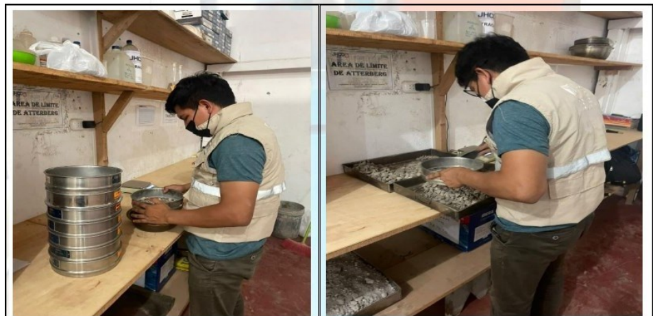
Fotos nº 03-04: En las imágenes se puede apreciar el ensayo de análisis granulométricos.
