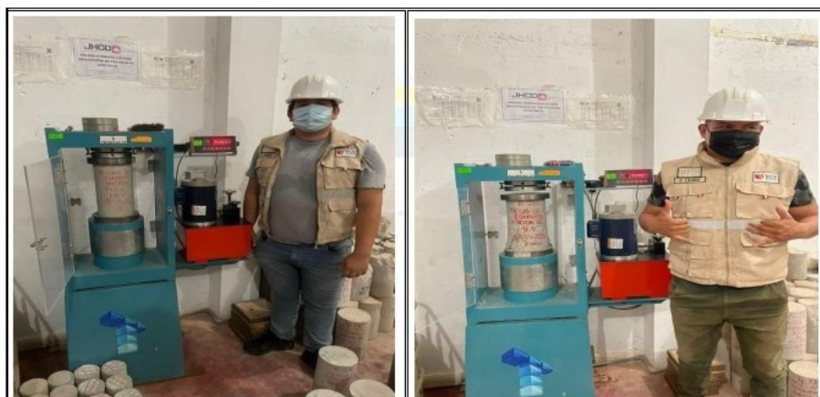
Fotos nº 15-16: En las imágenes podemos observar la resistencia a la compresión axial de los testigos de concreto
