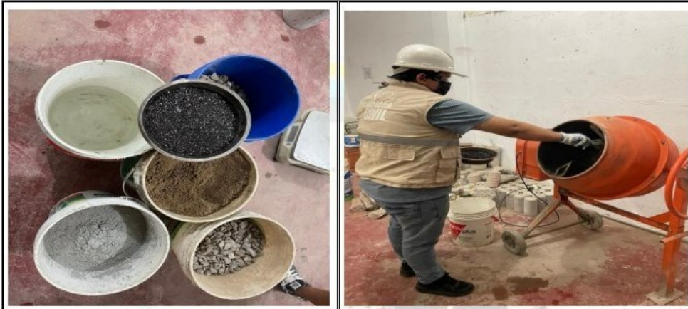
Fotos nº 09-10: En las imágenes podemos apreciar los materiales a utilizar para el diseño de concreto con adición de limadura de hierro.
