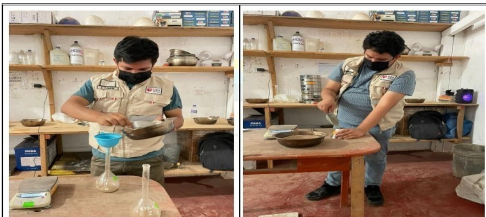
Fotos nº 05-06: En las imágenes podemos observar la realización del ensayo el peso específico
