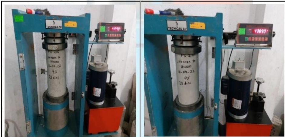
Fotos nº 17-18: En las imágenes podemos observar la resistencia a la compresión axial de los testigos de concreto
