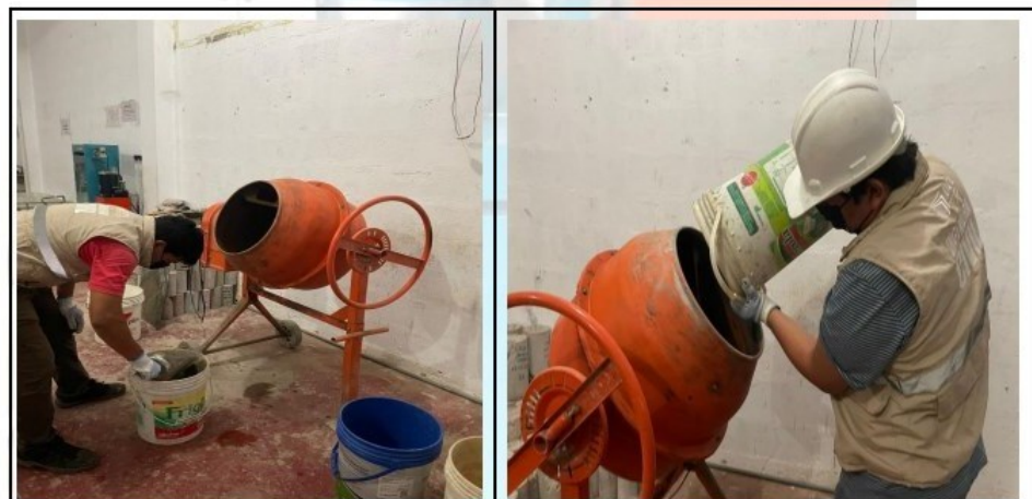
Fotos nº 09-10: En las imágenes podemos observar al personal realizando moldeo de los testigos de los diseños.
