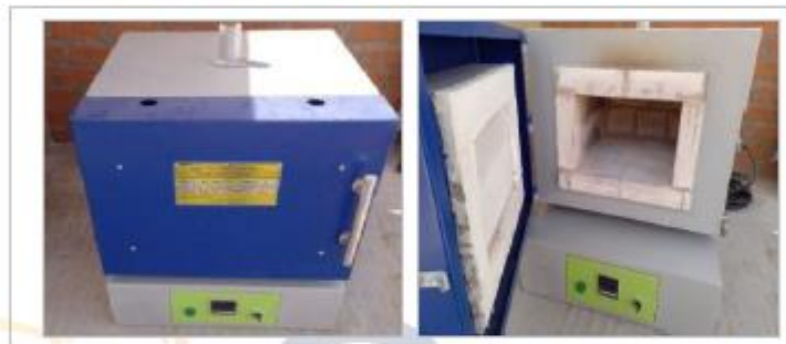
FIGURA N°1: MUFLA USADA EN LA CALCINACIÓN CONTROLADA
