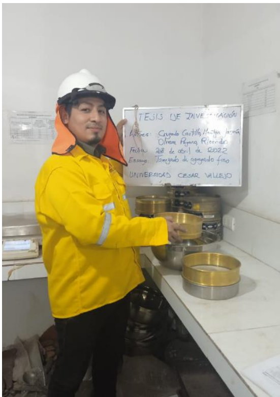
Figura 51: Tamizado Agregado Fino Fuente: Elaboración propia
