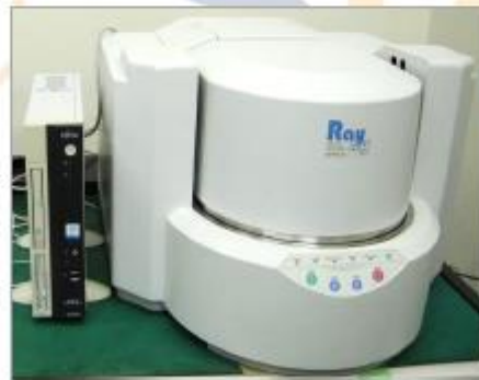
FIGURA N°3: EQUIPO DE FLUORESCENCIA DE RAYOS X
