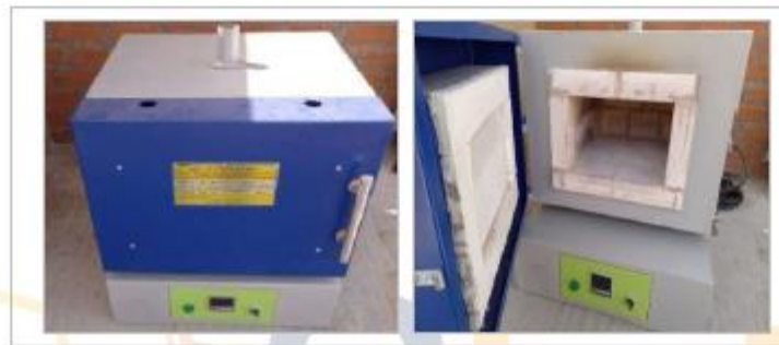
FIGURA N°1: MUFLA USADA EN LA CALCINACIÓN CONTROLADA
