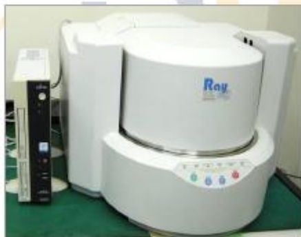
FIGURA N°3: EQUIPO DE FLUORESCENCIA DE RAYOS X
