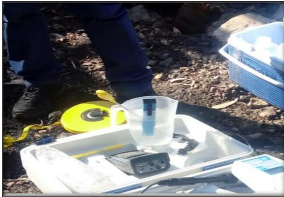
*Figura 3.* Medición de pH y temperatura
