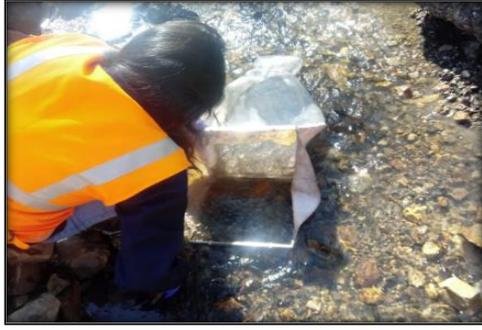
Figura 11. Colocación de la red de surber
