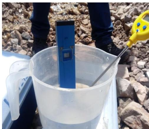
Figura 40: Medición de pH y temperatura
