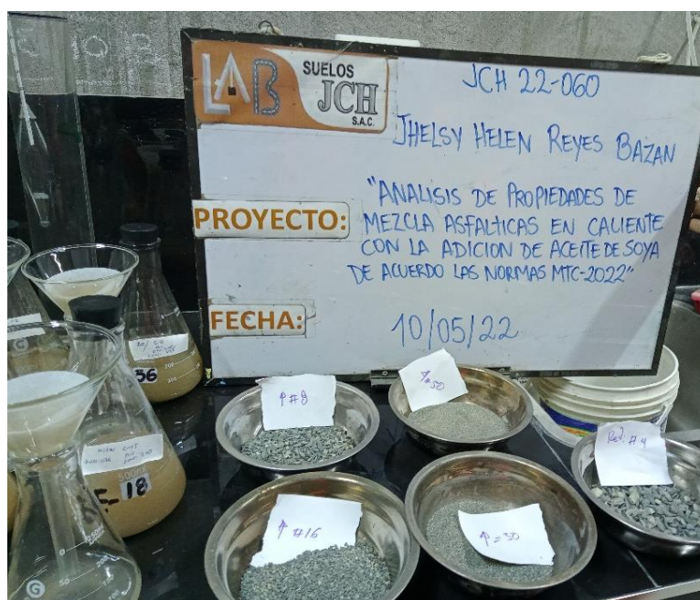
Figura 6. Muestras de los agregados para realizar el ensayo de Durabilidad.
