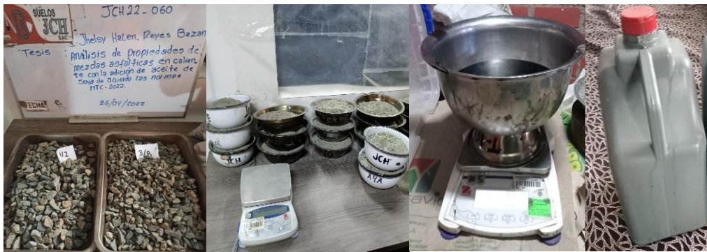
Figura 3. Componentes de la Mezcla Asfáltica en Caliente, agregados, cemento asfáltico y aceite de soya.
