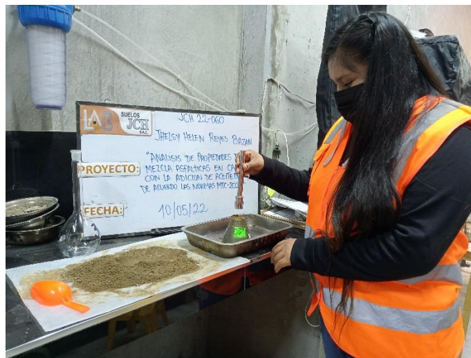
Figura 5. Ensayo para determinar la Gravedad Especifica y Absorción de agregados finos.
