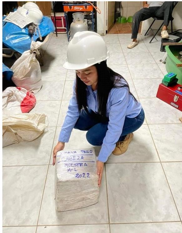
**Imagen 6.** Muestra inalterada para el ensayo de consolidación unidimensional.
