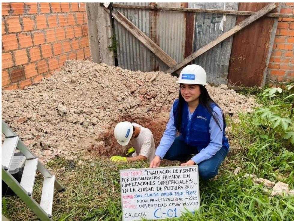
**Imagen 1.** Excavación de calicata C-01/sector Callería
