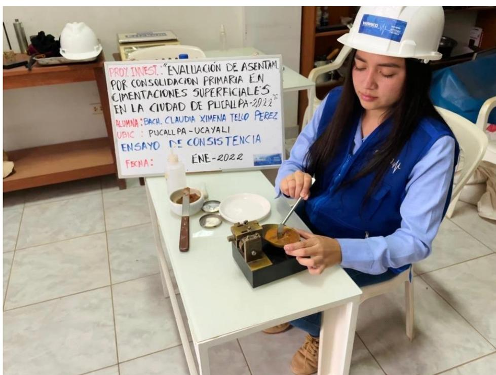
**Imagen 4.** Ensayos de Consistencia de las muestras extraídas.
