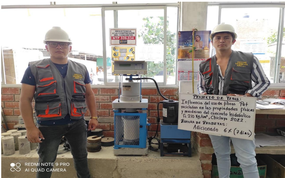
NOTA: Pruebas de las Vigas de concreto adicionando 6% de Pet a 28 días de edad.
