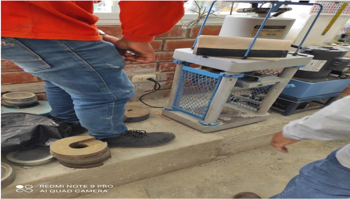
NOTA: Equipo para rotura de Probetas y Vigas de concreto.
