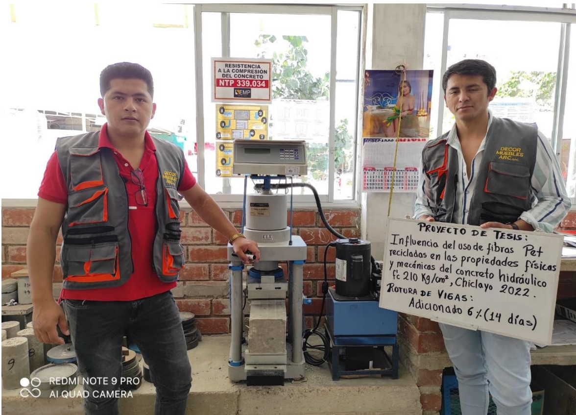
NOTA: Pruebas de las Vigas de concreto adicionando 6% de Pet a 14 días de edad.
