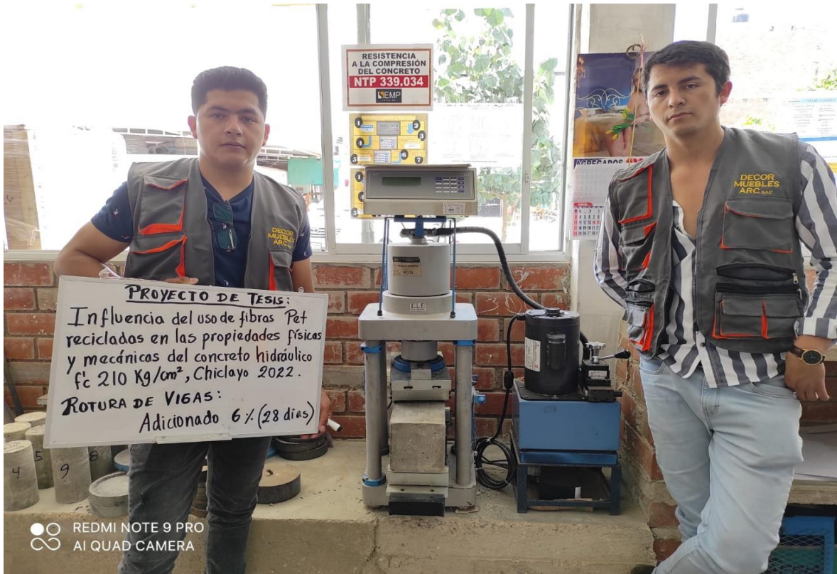
NOTA: Pruebas de las Vigas de concreto adicionando 6% de Pet a 28 días de edad.
