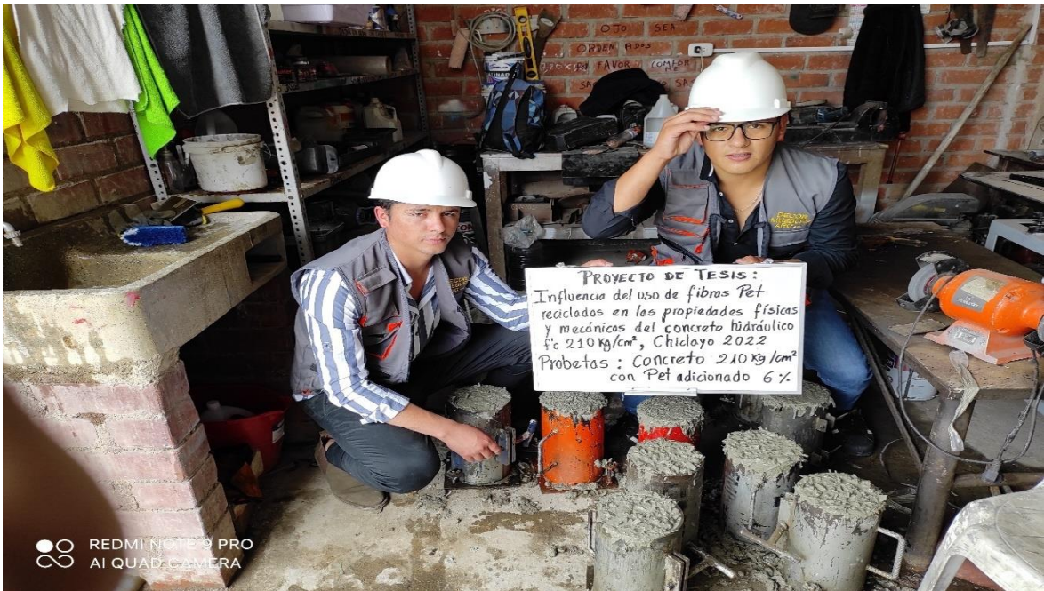
NOTA: Moldeo de las probetas de concreto adicionando las fibras de Pet recicladas.
