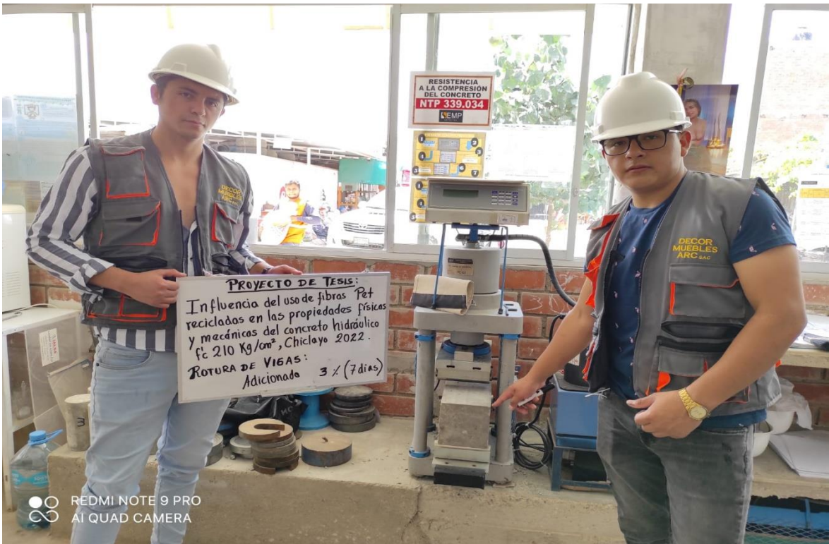
NOTA: Rotura de Vigas adicionado fibras Pet a una edad de 7 días.
