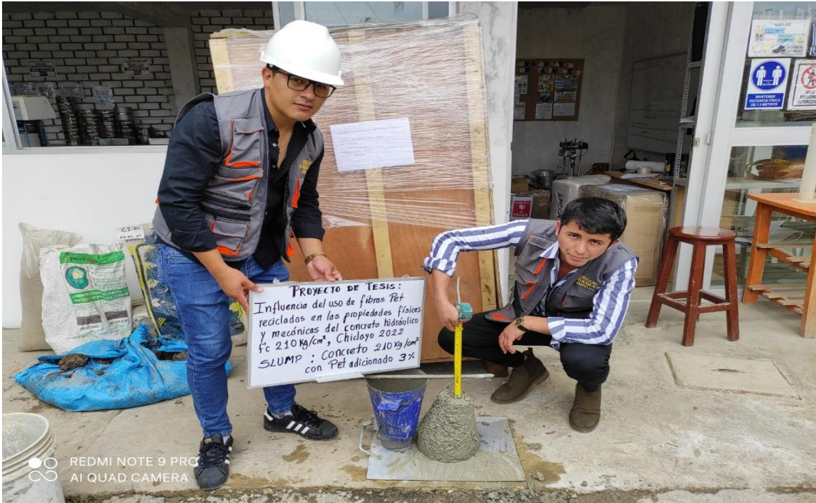
NOTA: Prueba del Slump para el diseño de Mezcla f_c= 210\text{kg/cm}^2 con Pet adicionado 3%
