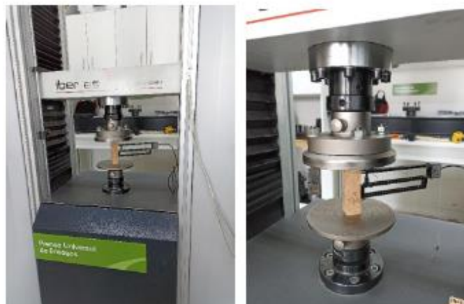
Ensayo de compresión paralela a las fibras.
