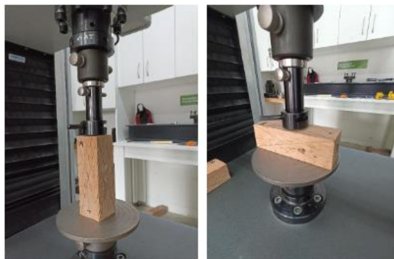
Ensayo de dureza en lados y extremos.
