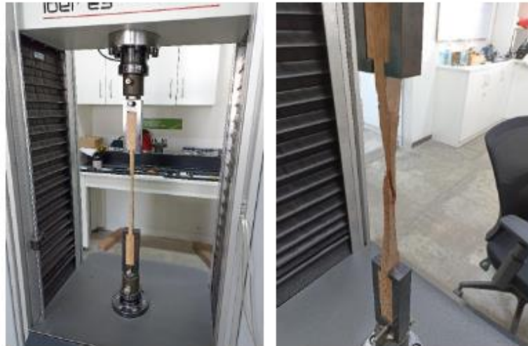
Ensayo de tensión paralela al grano.
