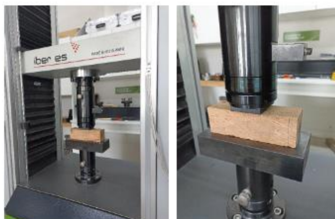
Ensayo de compresión perpendicular a las fibras.
