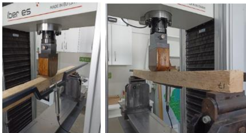
Ensayo de flexión estática.
