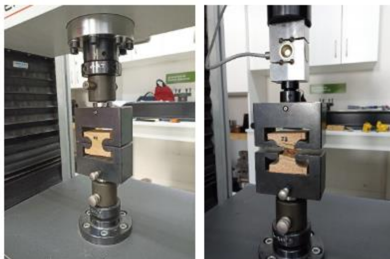
Ensayo de tensión perpendicular al grano.
