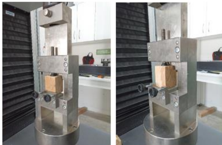
Ensayo de cizallamiento paralelo al grano.
