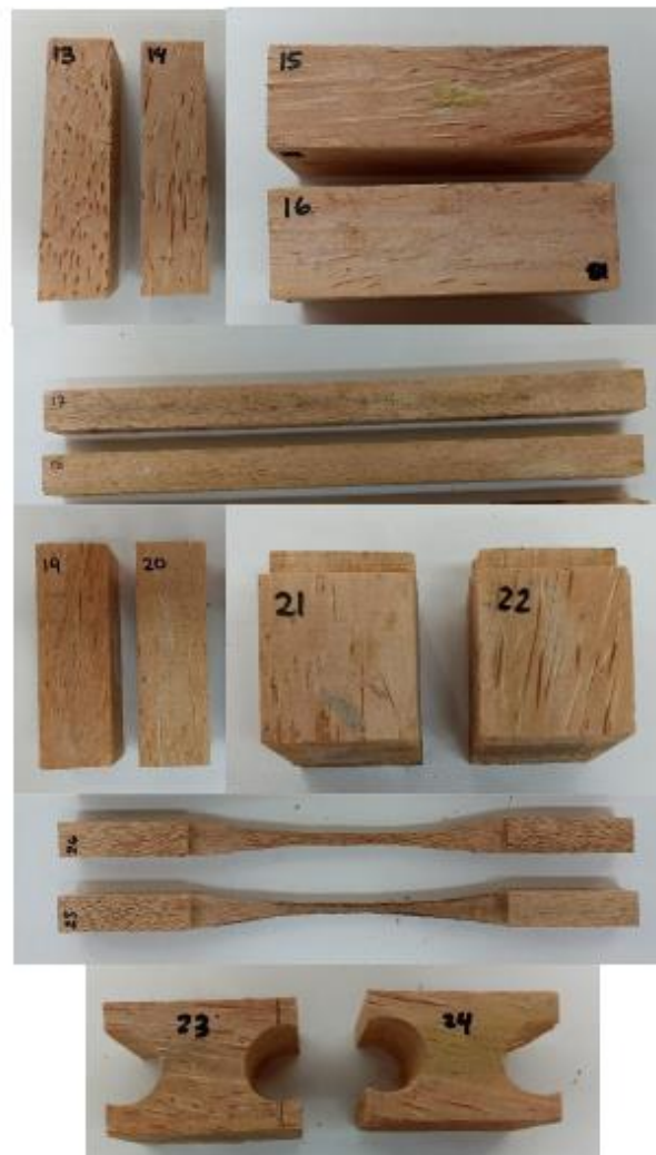
Figura 1. Muestras para ensayos mecánicos proporcionados por el cliente – Protocolos N° 013, 014, 015, 016, 017, 018, 019, 020, 021, 022, 023, 024, 025, 026
