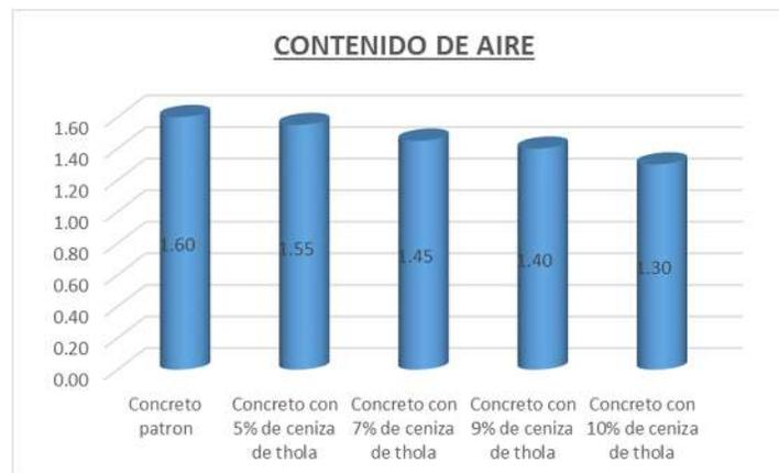
Según norma ASTM C231 el contenido de aire debe de encontrarse en el rango de 1% a 3% en este caso se encuentra dentro del rango normativo.
