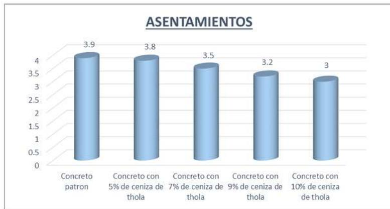
Para Lencinas F., Incahuanaco B. (2017) los asentamientos tienen una disminución hasta de -84.38% con adición de 10 % de ceniza de paja de trigo, considerando que cada puzolana reacciona de diferente forma según el proceso de obtención de la misma para la ceniza de thola se obtuvo una disminución de -23.08% para un 10% de adición, existiendo una coincidencia en la disminución del asentamiento mas no en los indicadores de porcentaje.
